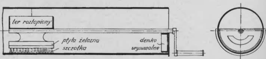
Ryc. 50. Terowanie wewnętrzne spojń rur (1:15).
