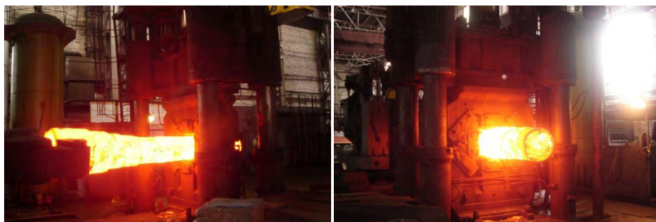
Rys. 2.13. Proces kucia obrotowego [24]
