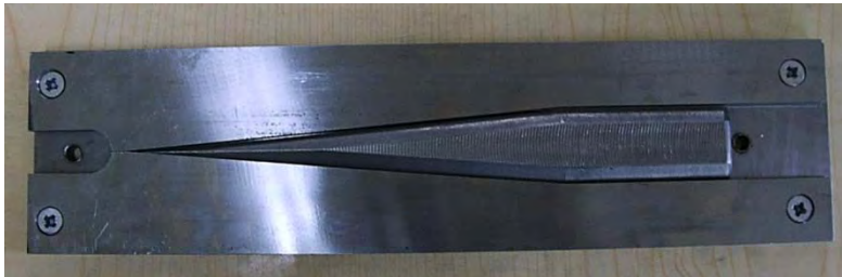
Rys. 2.26. Przykładowe narzędzie klinowe stosowane w procesie WKR na rolkach gładkich [38]
