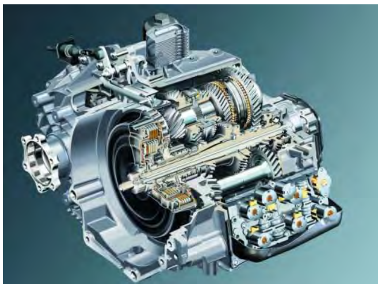
Rys. 2.6. Dwusprzęgłowa skrzynia biegów DSG [71]
