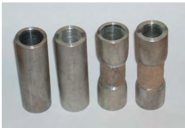
Rys. 5.15. Wsady drążone oraz ukształtowane wyroby wykonane ze stopu aluminium EN AW-6063
