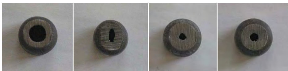
Rys. 5.9. Przekroje poprzeczne wyrobów finalnych ze stali R35 z odnotowanymi wadami kształtu: a) nieregularny kształt przekroju, b) przekrój owalny, c) deformacja powierzchni wewnętrznej oraz d) przekrój prawidłowy
