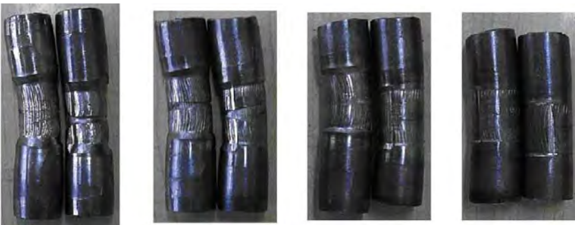
Rys. 2.27. Przykłady próbek uzyskanych w procesie WKR na rolkach gładkich [38]
