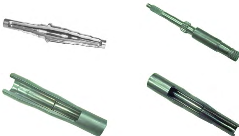
Rys. 2.12. Wałki drażone wykonane w procesie kowarkowym [65]
