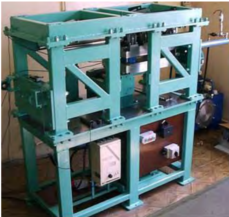
Rys. 2.24. Walcarka laboratoryjna LUW-2 przystosowana do walcowania klinowo – rolkowego [38]
