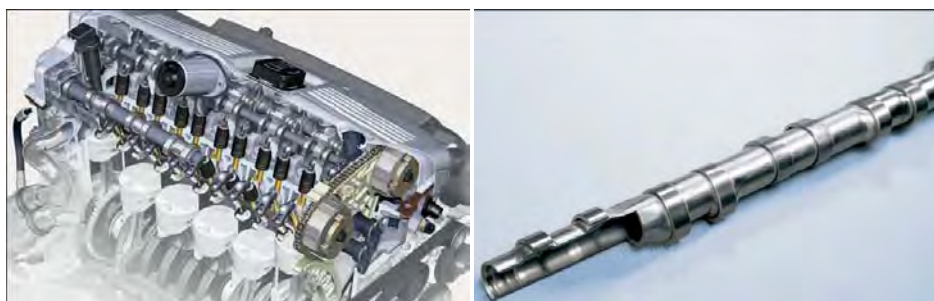
Rys. 2.2. Silnik z zastosowanym w nim drążonym wałkiem rozrządu [32]
