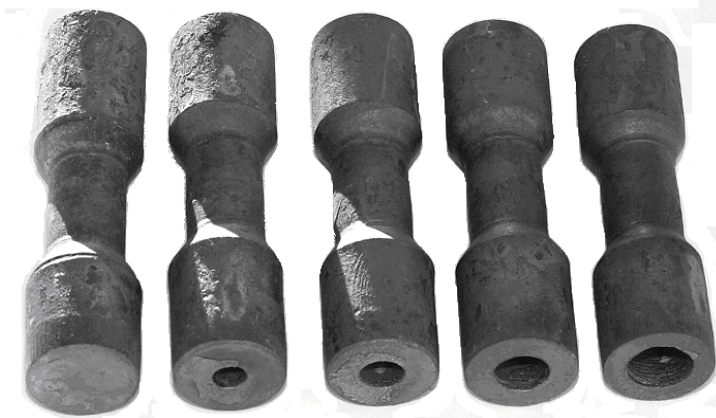
Rys. 2.29. Przykłady odkuwek ze stali C45 uzyskanych w procesie WKR [38]
