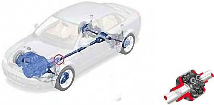
Rys. 2.4. Układ napędowy na cztery koła typu „quattro” [52]
