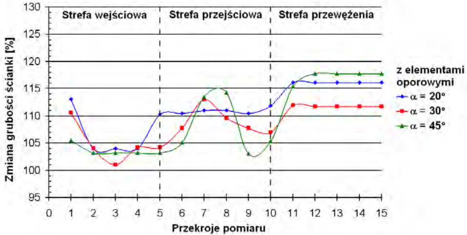
Rys. 4.20. Zmiana grubości ścianek odkuwek w przekroju wzdłużnym, odnotowana dla obciskania przy \delta = 1,19 i \gamma = 1^\circ 30' z zastosowaniem elementów oporowych
