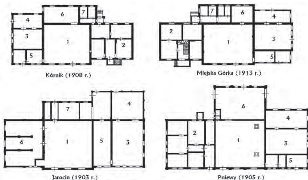
Rys. 1. Modelowe rozwiązania przestrzenne małej i średniej gazowni miejskiej
