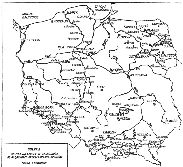
Rys. 2.1. Głębokość przemarzania gruntu w zależności od strefy klimatycznej w Polsce [3]
