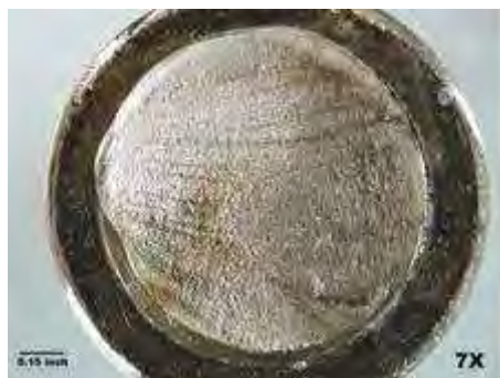
Rys 6. Optyczny fraktograf powierzchni zmęczeniowej
