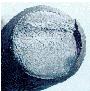
Rys. 2. Przełom zmęczeniowy śruby
