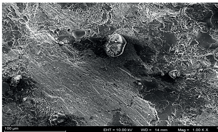
Rys. 6.51. Powierzchnia powłoki po zużyciu ściernym, powłoka zawierająca 30% ( \text{Al}_2\text{O}_3 -40% \text{TiO}_2 ), SEM [116].
