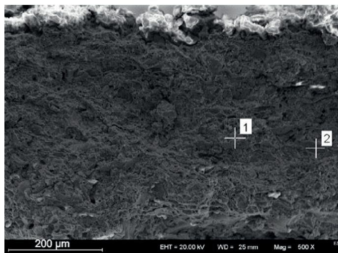
Rys. 6.31. Powierzchnia przełomu powłoki TBC po próbach w silniku ZI.
