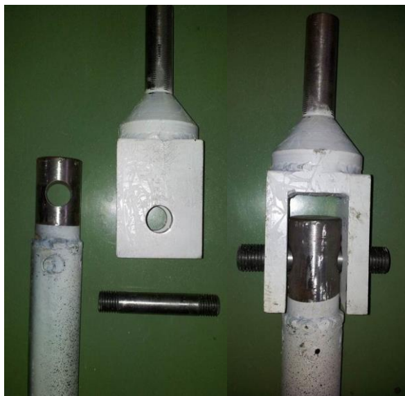
Rys. 4.3. Przegubowe zamocowanie próbki
