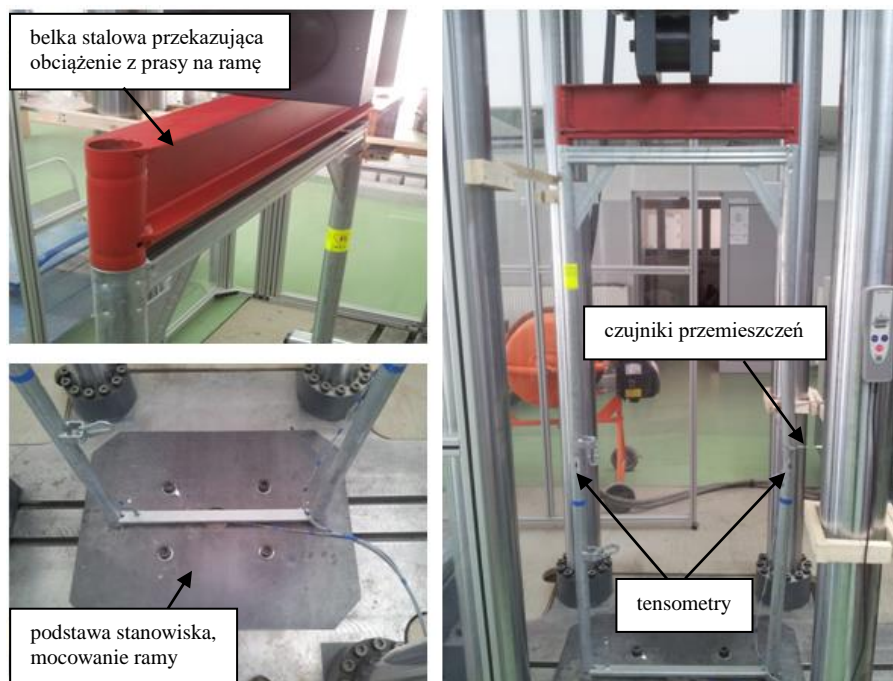
Rys. 4.7. Stanowisko do badań pełnej ramy systemu fasadowego rusztowań
