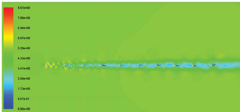
Rys. 7.21. Chwilowa prędkość wiatru w przypadku opływu wokół dziesięciu słupków kątem napływu wiatru 0^\circ
