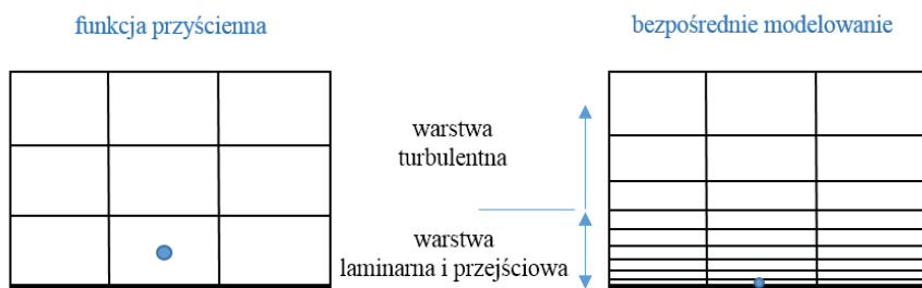
Rys. 7.5. Modelowanie warstwy przyściennej za pomocą: funkcji przyściennych i bezpośredniego modelowania [116], niebieski punkt oznacza środek pierwszej komórki
