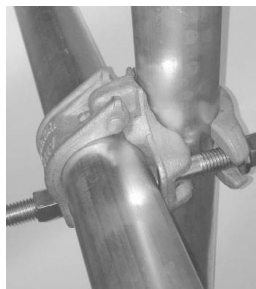
Rys. 3.43 Węzeł rusztowania rurowo-złączkowego
