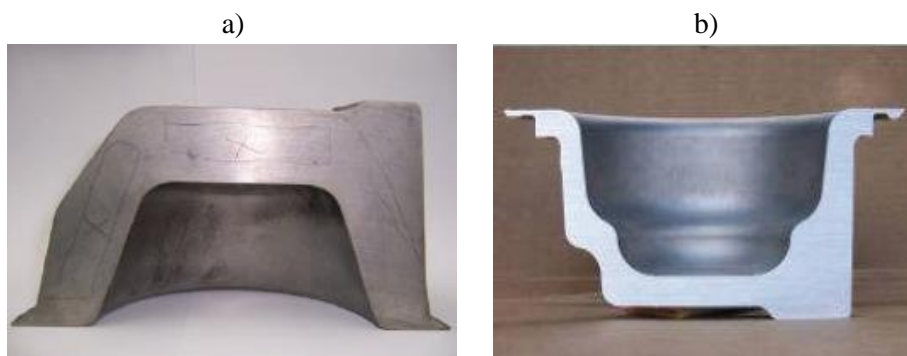
Rys. 1.51. Kształt odkuwki obudowy sprężarki ze stopu WE43 pokazany w przekroju poprzecznym po: a) pierwszej operacji kucia – zarejestrowana siła 5500 kN, b) drugiej operacji kucia – zarejestrowana siła 10500 kN [46]
