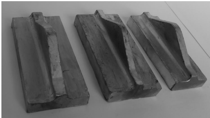
Rys. 6.16. Odkuwki z jednym żebrem o zarysie trójkątnym ze stopu AZ31 uzyskane w procesie kształtowania w wykroju zamkniętym w TPK
