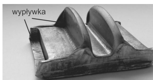
Rys. 6.30. Wypływka na powierzchniach czołowych odkuwki z dwoma żebrami
