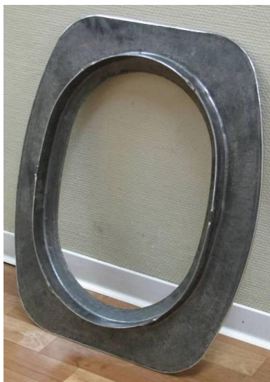
Rys. 1.45. Kształt odkuwki ramy okiennej samolotu Airbus ze stopu magnezu [45]
