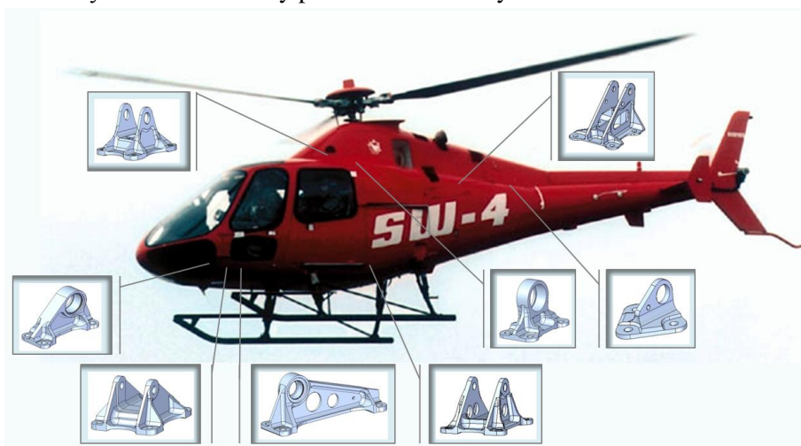
Rys. 1.2. Przykładowe wsporniki układu sterowania ze stopów magnezu wytwarzane z odlewów stosowane w budowie śmigłowców
