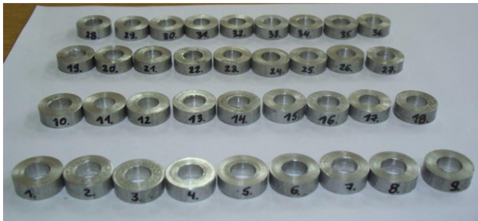
Rys. 4.15. Próbkki pierścieniowe ze stopu magnezu MgAl4Zn przygotowane do badań warunków tarcia
