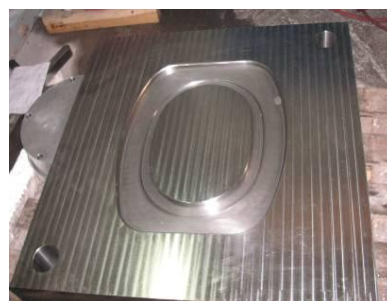
Rys. 1.47. Schemat oprzyrządowania do kucia odkuwki ramy okiennej samolotu [45]
