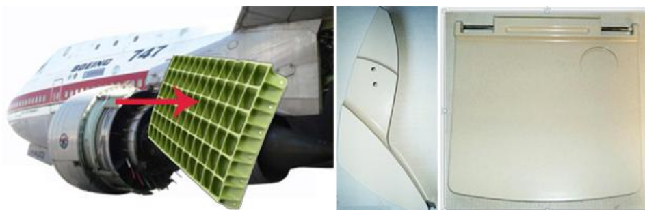
Rys. 1.28. Przykłady zastosowań stopów magnezu w samolocie Boeing 747: elementy skrzydeł i siedzeń [47]
