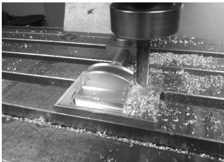
Rys. 8.5. Frezowanie odkuwki z dwoma żebrami na gotowy wspornik
