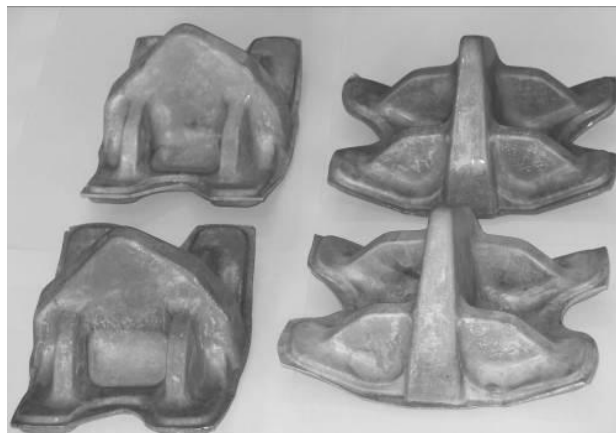
Rys. 1.13. Odkuwki uźebrowane kute matrycowo ze stopów aluminium PA31 i 2618A [101]
