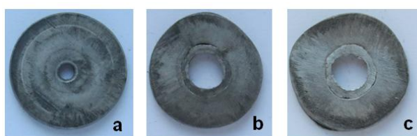
Rys. 4.20. Spęczone próbki ze stopu magnezu AZ31 nagrzane do temperatury 250°C: a) bez smarowania, b) ze smarowaniem dwusiarczkiem molibdenu, c) ze smarowaniem łojem z grafitem
