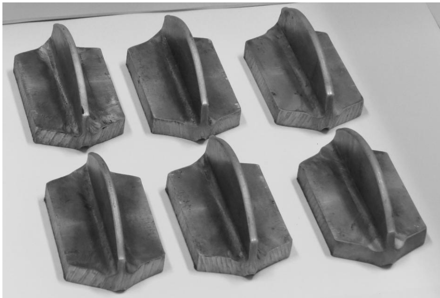
Rys. 6.14. Odkuwki z jednym żebrem ze stopu AZ31 uzyskane w procesie kształtowania półswobodnego w TPK
