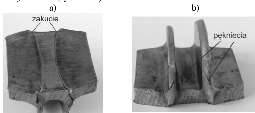
Rys. 6.28. Przykładowe odkuwki dwużebrowe z zakuciem w podstawie (a) oraz z pęknięciami i nierównomiernością wysokości i grubości żeber (b)
