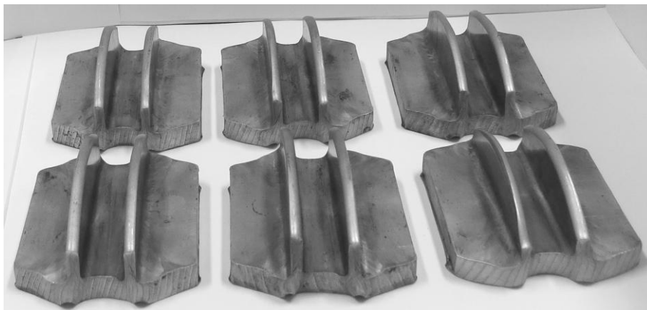
Rys. 6.25. Odkuwki z dwoma żebrami ze stopu AZ31 uzyskane w procesie kształtowania półswobodnego w TPK
