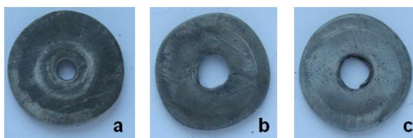
Rys. 4.21. Spęczone próbki ze stopu magnezu AZ31 nagrzane do temperatury 350°C: a) bez smarowania, b) ze smarowaniem dwusiarczkiem molibdenu, c) ze smarowaniem łojem z grafitem
