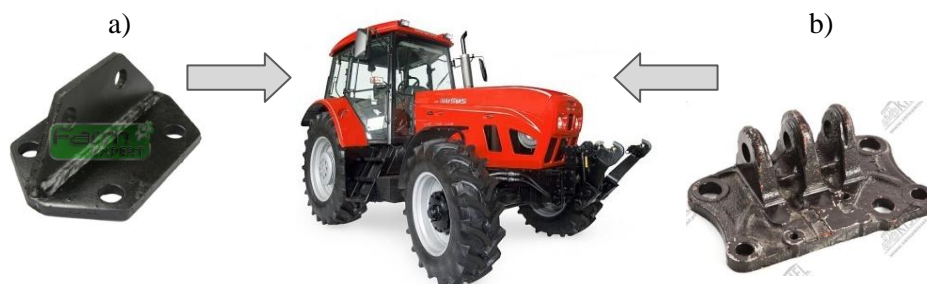
Rys. 1.9. Wsporniki ciągnika rolniczego: a) siłownika podnośnika, b) błotnika przedniego [53, 63]
