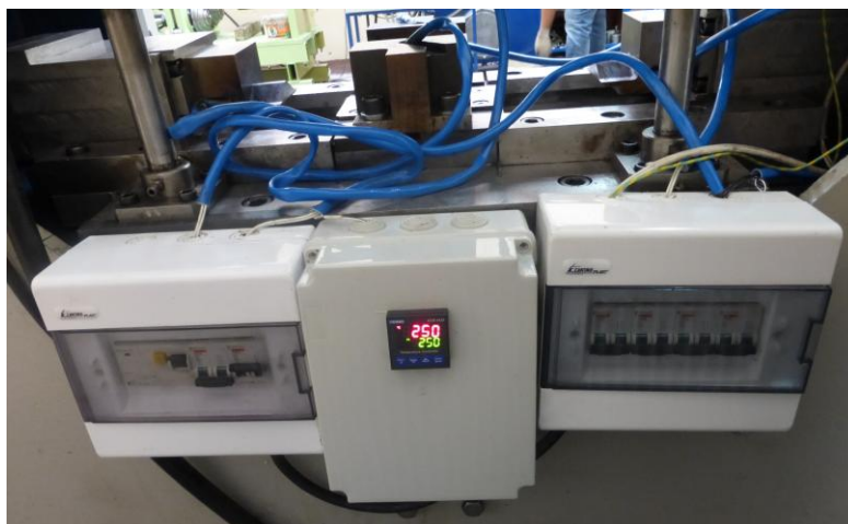
Rys. 6.13. Układ sterujący systemu grzewczego wykorzystany do badań
