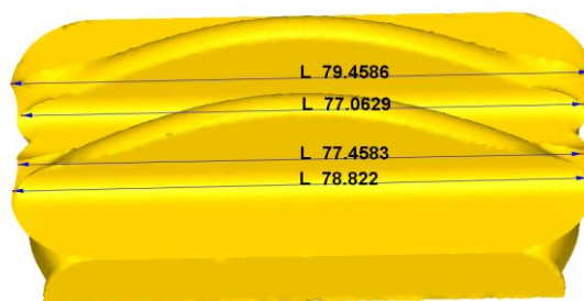
Rys. 3.1. Sposób pomiaru poszerzenia podstawy odkuwki z dwoma żebrami uzyskanej na drodze symulacji numerycznych
