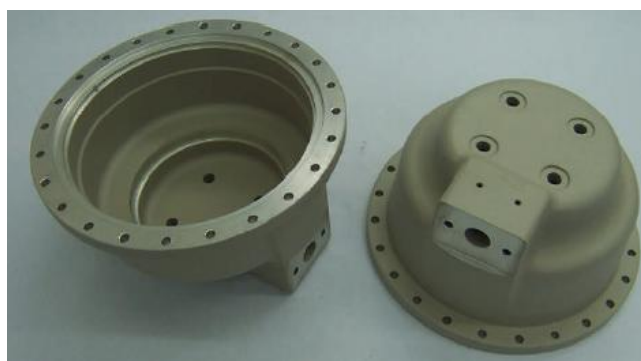
Rys. 1.52. Odkuwka obudowy sprężarki dla systemu klimatyzacyjnego ze stopu magnezu WE43 [46]
