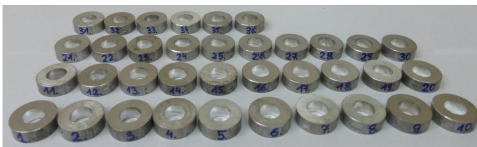
Rys. 4.16. Próbkki pierścieniowe ze stopu magnezu AZ31 przygotowane do badań warunków tarcia
