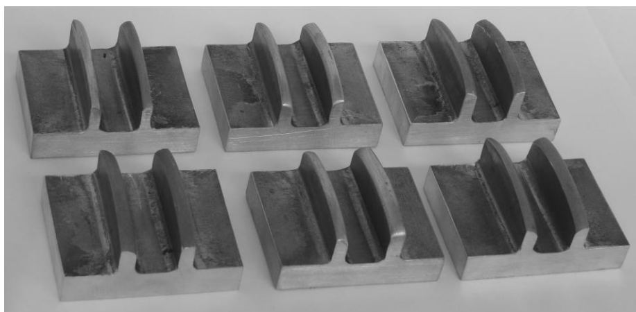
Rys. 6.26. Odkuwki z dwoma żebrami ze stopu AZ31 uzyskane w procesie kształtowania w wykroju zamkniętym w TPK
