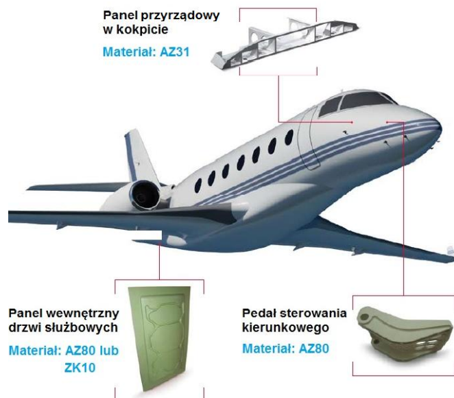
Rys. 1.29. Zastosowanie stopów magnezu w lotnictwie [2]
