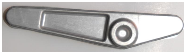
Rys. 1.54. Odkuwka dźwigni lotniczej ze stopu AZ31 [33]
