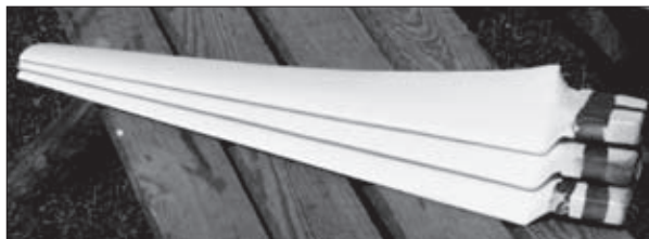
Rys. 2. Łopaty silnika wiatrowego po pomalowaniu
