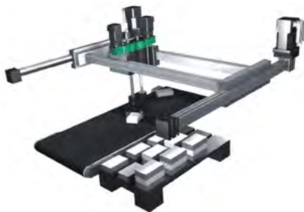
Rys. 3. System sortowania jako przykład sterowania przestrzennego w układzie prostokątnym
