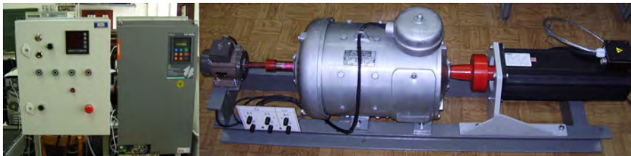
Rys. 7. Po lewej: widok panelu operatorskiego oraz przekształtnika, po prawej: silnik PMSM obciążony prądnicą obcowzbudną prądu stałego
