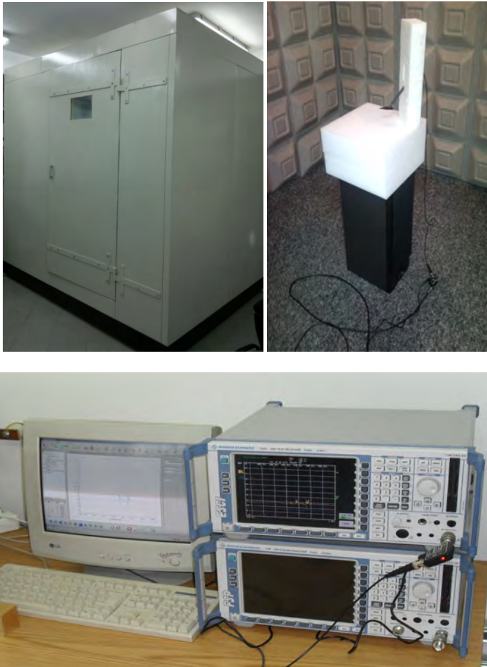
Rys. 2. Stanowisko badań: komora i jej wnętrze oraz odbiornik pomiarowy ESCI3
