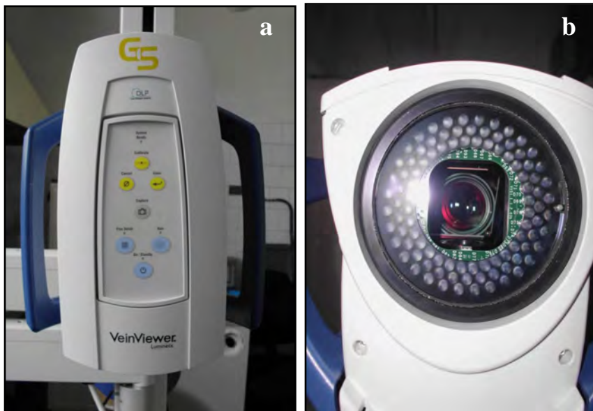
Rys. 1. VeinViewer: głowica aparatu (a – panel sterowania, b – źródło promieniowania IR i układ optyczny)
