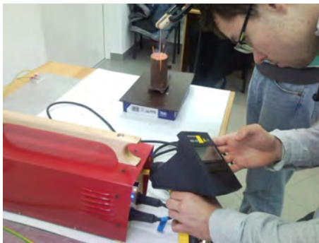
Rys. 4. Badanie odporności, a) testowanie spawarki generatorem ESD NSG 435 firmy Schaffner, b) widok na generator zaburzeń elektromagnetycznych Modula 6000
