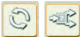
Rys. 2. Bloki podstawowych funkcji organizowania kodu: blok pętli (z lewej), blok wyboru /decyzji (z prawej)
