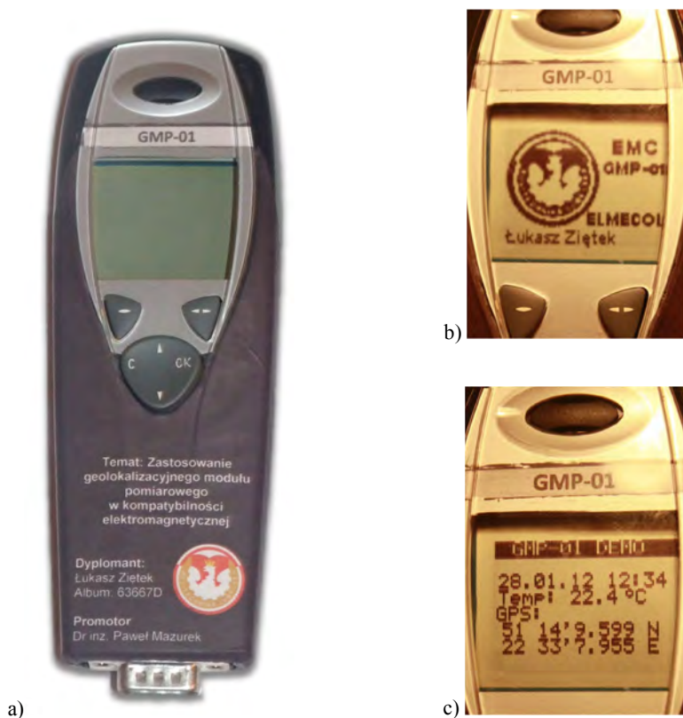
Rys. 6. Zdjęcie wykonanego Geolokalizacyjnego modułu pomiarowego: a) widok całego urządzenia, b) ekran powitalny, c) ekran demonstracyjny (położenie w laboratorium EMC Politechniki Lubelskiej)
