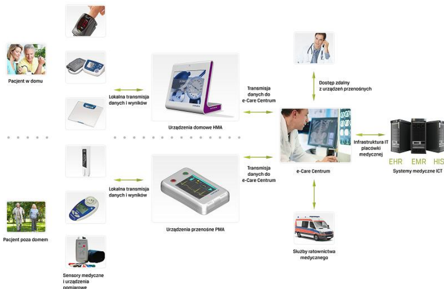
Rysunek 3.3. Schemat budowy i działania systemu [8]
