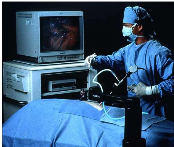
Rys. 10.8. Mocowanie do endoskopu zautomatyzowanego ramienia za pośrednictwem magnetycznego pierścienia [36]
