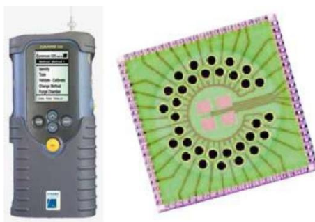
Rys.8.4. Sztuczny nos Cyranose 320; a) widok ogólny, b) matryca 32 czujników polimerowych CP [18]
