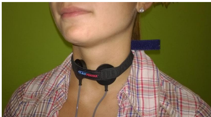
Rys. 6.3. Elektrody elektrolottografu umieszczone na szyi pacjenta
