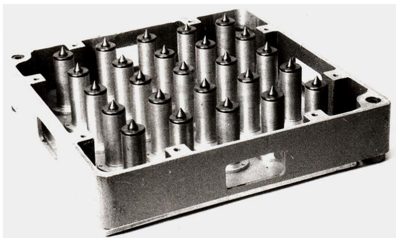
Rys. 4.6. Uniwersalna kasetka do bazowania części w ZKT tokarskim
