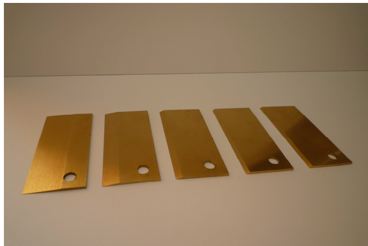
Rys. 5.18. Komplet noży z naniesioną powłoką TiN
