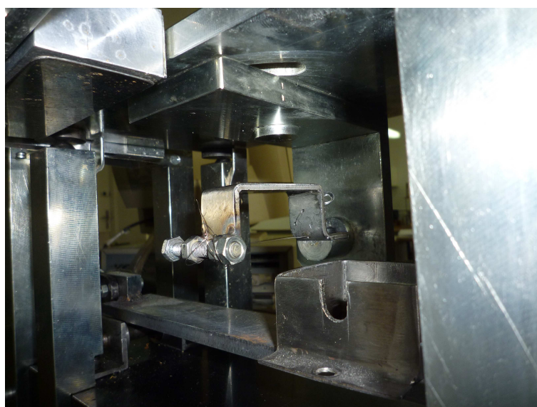
Rys. 5.6. Widok stanowiska z zamocowanym uchwytem dla technologii cięcia drutem
