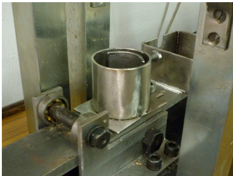
Rys. 5.4. Uchwyt do cięcia korzeni marchwi prostopadle do ich osi
