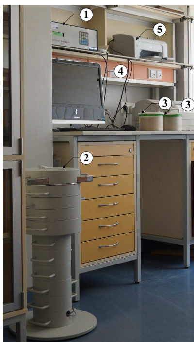
Rys. 5.6. Widok stanowiska badawczego; 1 – sterownik mikroprocesorowy, 2 – domek osłonowy, 3 – pojemniki z próbkami, 4 – komputer, 5 – drukarka
