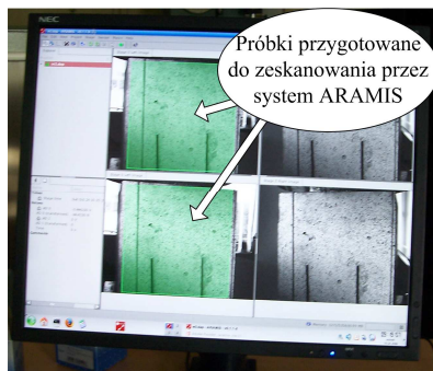
Rys. 6.24. Widok próbek do zeskanowania przez program systemu ARAMIS
