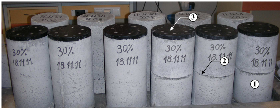
Rys. 6.41. Partia próbek walcowych przygotowana do badań odporności na pękanie; 1 – próbka betonowa, 2 – rysa pierwotna, 3 – zabetonowana dolna płyta
