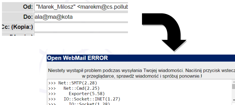
Rys. 2.27. Przykład braku agnostycyzmu danych: formularz z wypełnionymi polami danych i reakcja aplikacji na dane Źródło: opracowanie własne
