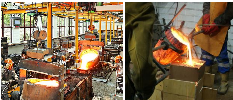
Rys. 10.57. Zalewanie grawitacyjne form piaskowych przebiegające z wykorzystaniem kadzi odlewniczej dźwignicowej (po lewej) oraz kadzi z widłami (po prawej) [27, 29]
