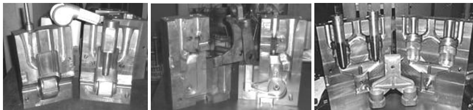
Rys. 10.73. Przykłady metalowych form odlewniczych (kokili) wraz z wykonywanymi w nich odlewami
