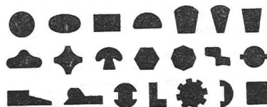
Rys. 8.5. Przykładowe kształty przekroji poprzecznych drutów otrzymanyh metodą ciągnięcia [107]
