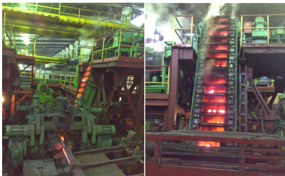
Rys. 7.58. Walcowanie skośne kul na mielniki w jednym z zakładów rosyjskich [137]
