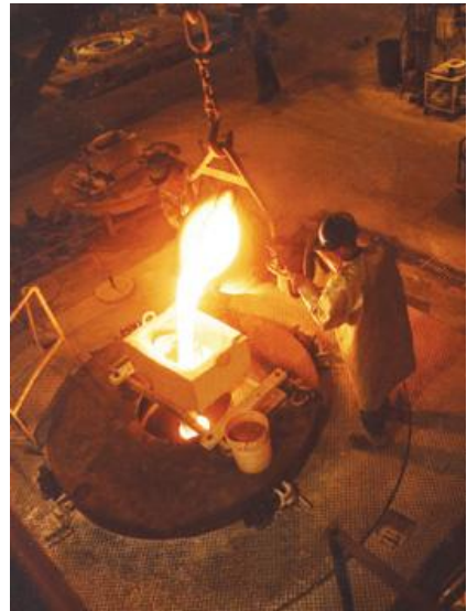
Rys. 10.78. Odlewanie odśrodkowe właściwe o pionowej osi obrotu: schemat procesu (po lewej) oraz stanowisko przemysłowe (po prawej); na podstawie [105, 159]
