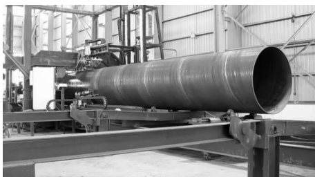
Rys. 7.55. Spawanie elektryczne w otulinie topników rury ze szwem spiralnym; na podstawie [93]
