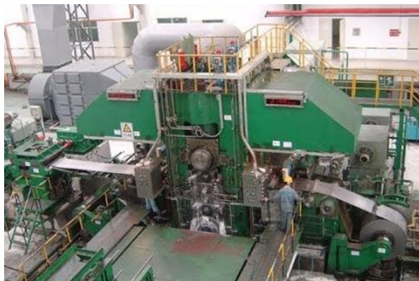
Rys. 7.27. Walcarka nawrotna sześciowalcowca do walcowania taśm na zimno [1]
