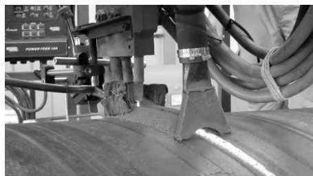
Rys. 7.55. Spawanie elektryczne w otulinie topników rury ze szwem spiralnym; na podstawie [93]
