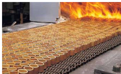
Rys. 9.28. Przykład procesu spiekania wyprasek otrzymanych z proszku metali
