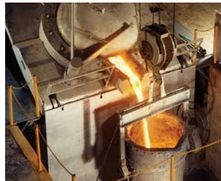
Rys. 4.23. Elektryczny piec indukcyjny (po lewej) oraz spust stali uzyskanej w takim piecu (po prawej); na podstawie [50, 126]
