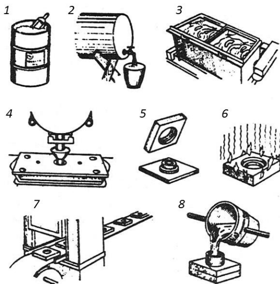
Rys. 10.71. Proces technologiczny odlewania wg metody Shawa: 1 - przygotowanie materiałów ceramicznych, 2 - przygotowanie spoiwa, 3 - sporządzanie mieszanki, 4 - zalanie formy mieszanką ceramiczną, 5 - oddzielenie formy od modelu, 6 - wypalanie formy, 7 - wygrzanie formy, 8 - zalanie ciekłym metalem [111]
