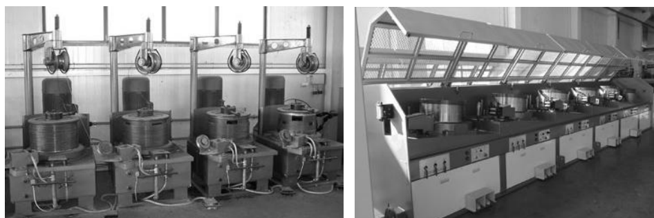
Rys. 8.18. Przykłady wielociągów bez poślizgu: układ blokowy zestawiony z jednociągów (po lewej) [85], ciągarka prostoliniowa z przeciwnociągiem wytworzonym przez rolki dociskowe (po prawej) [158]
