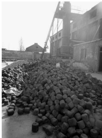
Rys. 5.4. Koks formowany; w tle żeliwiak
