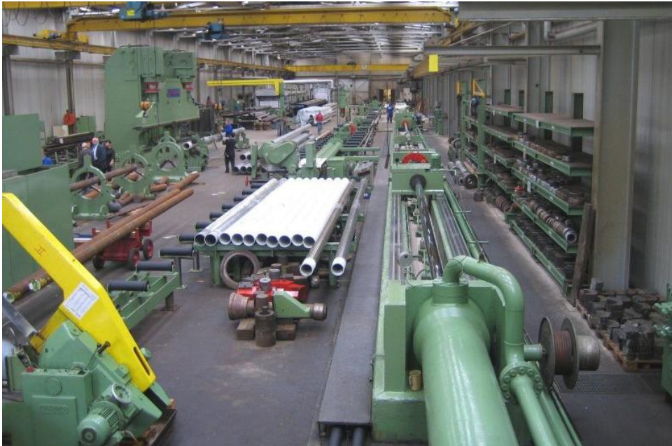
Rys. 8.24. Przykład nowoczesnej ciągarni rur, w której wykorzystywane są ciągarci ławowe [48]
