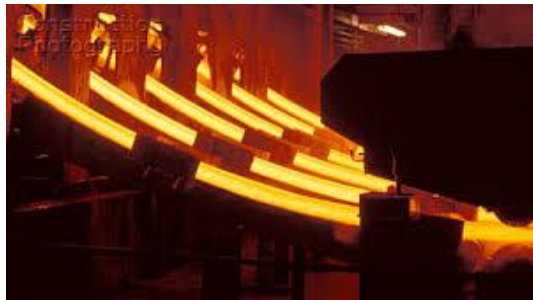
Rys. 4.34. Przykładowe rozwiązanie służące do 6 - żyłowego odlewania ciągłego stali [17]
