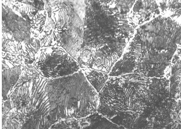
Rys. 1.5. Mikrostruktura stali N13 w stanie przegrzanym: trawienie - nital, powiększenie 250x (widoczne są ciemne ziarna perlitu oraz jasny cementyt wtórny na granicach ziaren) [109]
