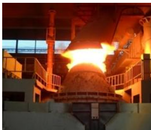
Rys. 4.26. Argonowanie stali (proces AOD): schemat konwertora (po lewej) oraz widok procesu w okresie odwęglania (po prawej) [51, 64]
