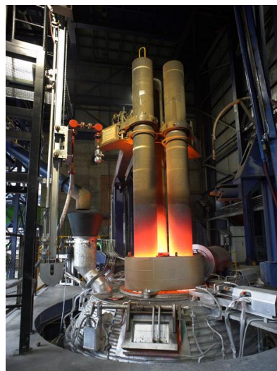
Rys. 4.25. Rafinacja stali w piecu kadziowym: schemat procesu (po lewej) oraz piecokadz w widoku (po prawej) [65, 70]
