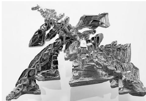
Rys. 1.8. Schemat dendrytu (po lewej) [14] oraz kryształ srebra o budowie dendrytycznej (po prawej)
