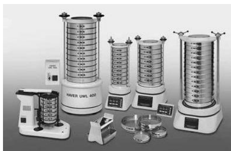
Rys. 9.10. Programowane wstrząsarki do analiz sitowych z zestawami sit normowych [121]
