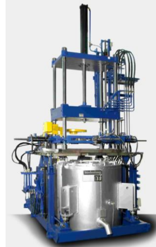
Rys. 10.75. Schemat odlewania kokilowego niskociśnieniowego (po lewej) oraz maszyna do odlewania niskociśnieniowego odlewów ze stopów aluminium, wykorzystująca sprężone powietrze (po prawej); na podstawie [37, 66]
