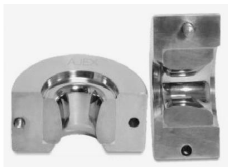
Rys. 8.12. Ciągadło z wkładką (rdzeniem) z węglika spiekanego
