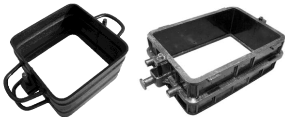
Rys. 10.31. Skrzynki formierskie: ręczna (po lewej) i suwnicowa (po prawej) [3, 129]
