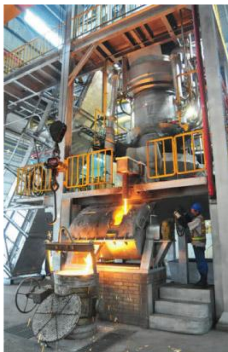
Rys. 5.17. Żeliwiak gazowy (bezkoksowy) (LPG), o wydajności 10 ton na godzinę [139]
