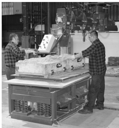
Rys. 10.55. Zagęszczanie masy w skrynkach formierskich realizowane na stole wibracyjnym z kontrolą częstotliwości zagęszczenia [91]
