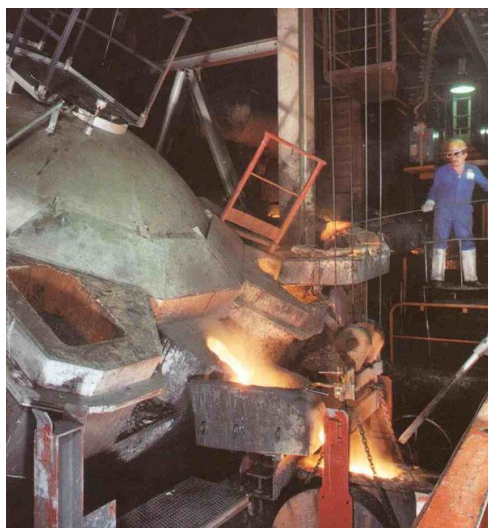
Rys. 5.20. Wytop żeliwa w piecu indukcyjnym kanałowym (po lewej) oraz przekrój przez induktor tego pieca (po prawej), gdzie: 1 - rdzeń induktora, 2 - cewka, 3 - kanał wypełniony metalem tworzący tzw. uzwojenie wtórne, 4 - połączenie ze zbiornikiem pieca, 5 - ciekły metal; na podstawie [4, 97]
