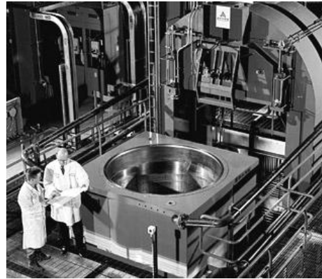
Rys. 9.19. Przykładowa komora ciśnieniowa stosowana w prasowaniu izostatycznym proszków
