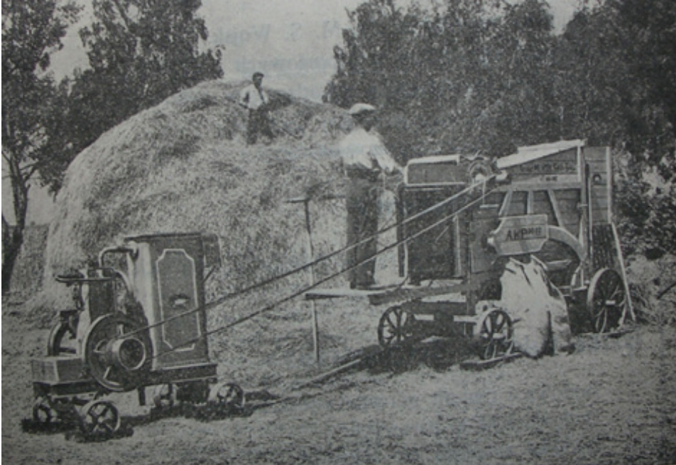
Ryc. 45. Młockania czyszcząca z motorem własnej produkcji o mocy 5 KM, fabryki M. Wolski i S-ka, fragment reklamy prasowej pojawiającej się na łamach Technika Lubelskiego z 1930 roku
