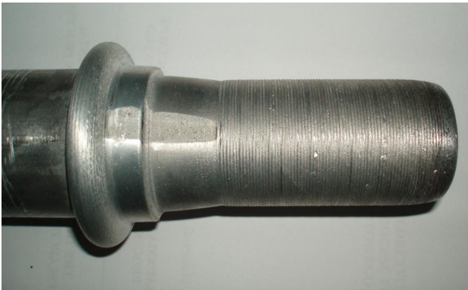
Rys. 5.18. Zaznaczenie zarysu rolek narzędziowych na przepychanym obrotowo wyrobie pełnym ( p=7,5\text{mm/obr.} ) [9]
