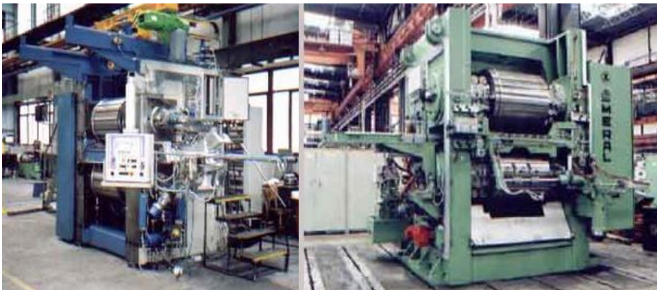
Rys. 2.22. Dwuwalcowa walcarki poprzeczno – klinowe firmy (Šmeral – Czechy) [85]
