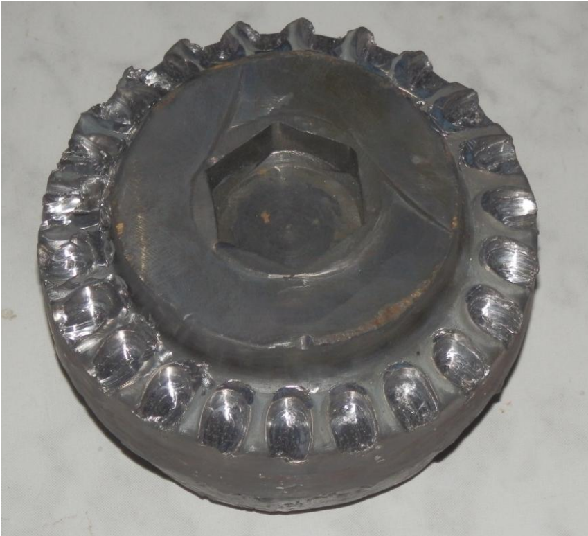
Rys. 6.49. Wyrób stopniowany z ukształtowanym zarysem uzębienia czołowego oraz gniazdem sześciokątnym - materiał: ołów Pb1
