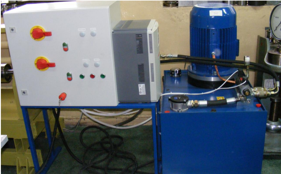
Rys. 4.5. Szafa sterownicza z pulpitem sterującym i falownikiem wektorowym oraz zasilacz hydrauliczny wyposażony w zawory dławiące
