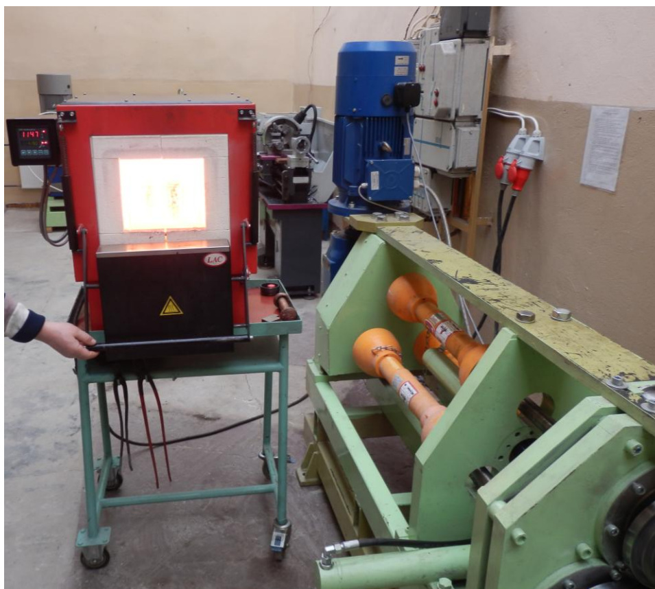
Rys. 4.16. Piec komorowy firmy LAC wykorzystywany do nagrzewania wsadów badawczych
