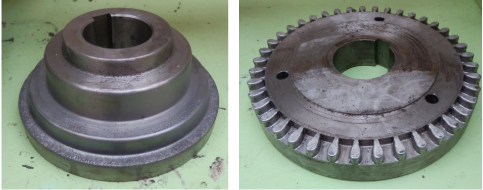
Rys. 6.38. Wykonane ze stali 40H przykładowe rolki obrotowe
