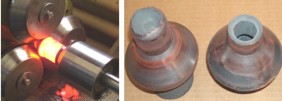
Rys. 5.8. Proces przepychania obrotowego wyrobu pełnego ( p = 5 mm/obr.) oraz uzyskane wyroby gotowe (stal C45) [9]
