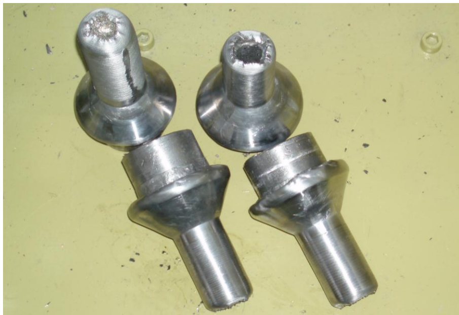
Rys. 5.4. Wyroby pełne oraz drążone uzyskane w procesie przepychania obrotowego (materiał – ołów Pb1) [9]
