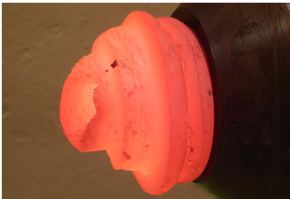
Rys. 6.44. Zdeformowany wyrób drążony powstały w wyniku zbyt szybkiego podawania materiału do przestrzeni roboczej pomiędzy rolkami
