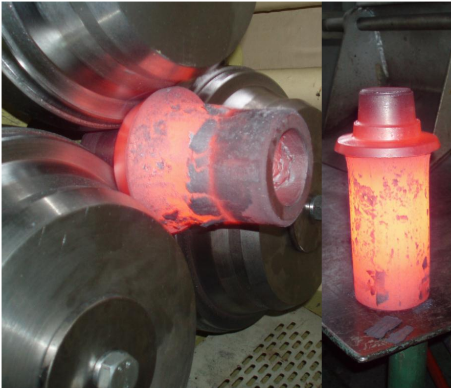
Rys. 5.16. Proces przepychania obrotowego drążonego wałka stopniowanego z zastosowaniem zaprojektowanych narzędzi rolkowych oraz uzyskany wyrób pełny ( p = 5 \text{ mm/obr.} ) [9]
