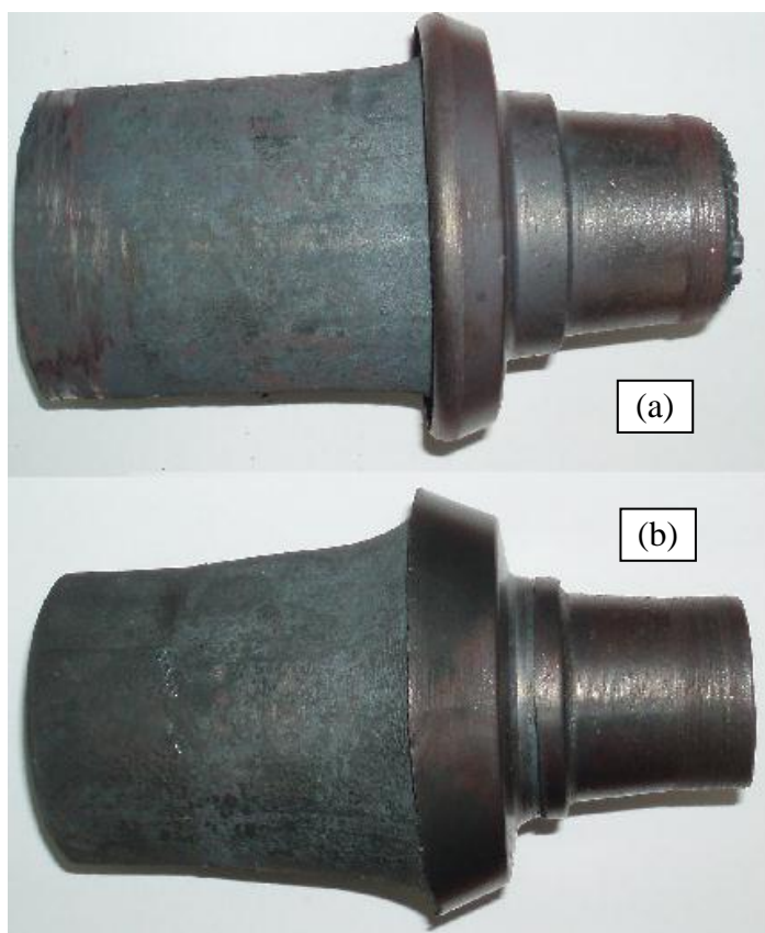
Rys. 5.17. Wpływ różnych wartości posuwu na obrót p na uzyskiwany kształt wyrobu finalnego: (a) p = 2,5 \text{ mm/obr.} ; (b) p = 7,5 \text{ mm/obr.} [9]
