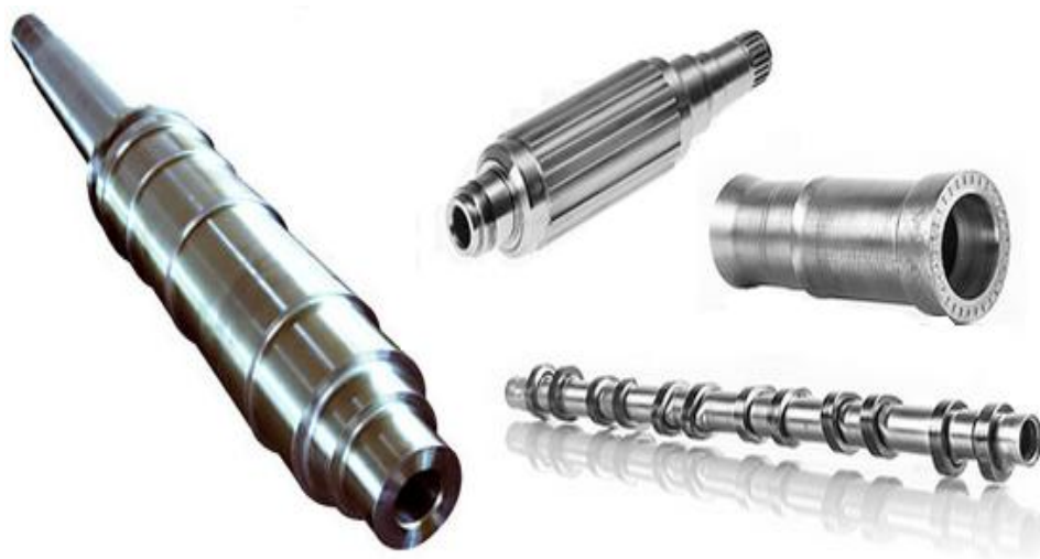
Rys. 2.5. Wybrane model wałków drążonych jednolitych oraz łączonych z półfabrykatów [90, 91]
