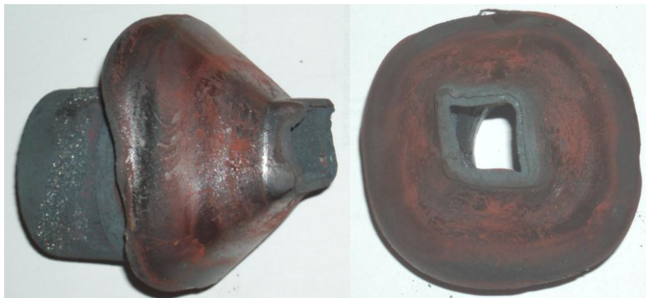
Rys. 5.7. Przykładowy wyrób zniszczony w wyniku wystąpienia zjawiska poślizgu ( p = 5 \text{ mm/obr.} )
