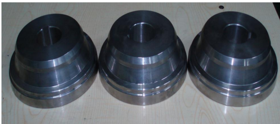
Rys. 5.15. Rolki robocze do procesu przepychania obrotowego wykonane wg rys. 5.13.
