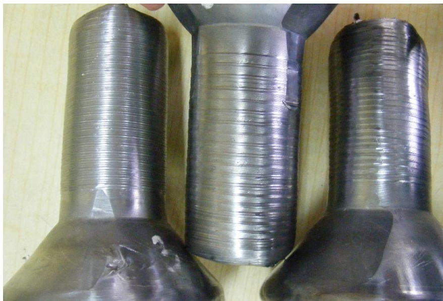
Rys. 5.1. Przepychane obrotowo wyroby wykonywane z ołowiu gatunku Pb1 w trakcie prób funkcjonalno – ruchowych agregatu PO-1 bez zastosowania głowicy obrotowej montowanej na popychaczu [9]
