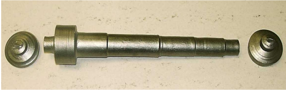
Rys. 2.25. Odkuwka wałka pośredniego wraz z odpadami końcowymi odcinanymi w trakcie procesu WPK [50]
