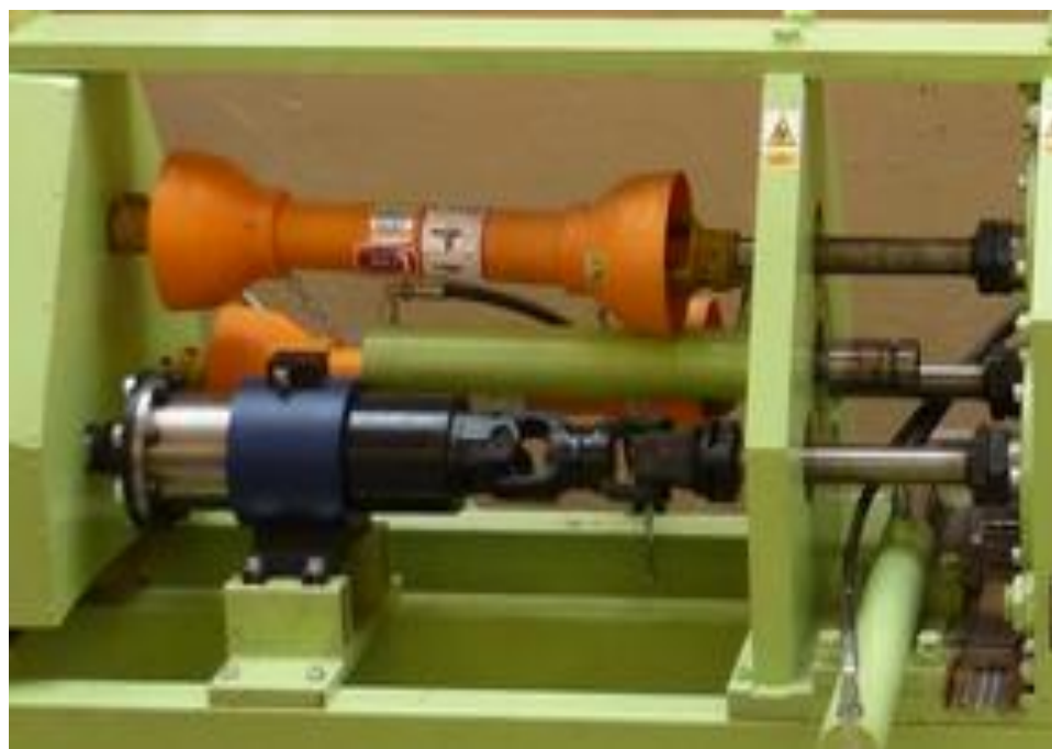
Rys. 6.47. Zabudowany w miejsce jednego z wałów czujnik momentu obrotowego (widoczna tylna głowica obrotowa agregatu (przedstawiona na rys 6.36)
