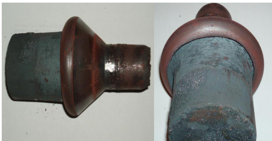
Rys. 5.10. Wyroby pełny z charakterystycznym, wstecznym wywinięciem krawędzi kołnierza, spowodowanym zbyt małą wartością posuwu na obrót p ( p = 2,5 \text{ mm/obr.} ) [9]
