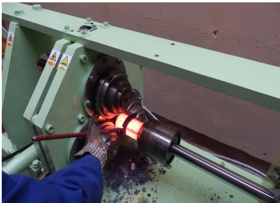
Rys. 6.40. Wprowadzenie wsadu do przestrzeni roboczej oraz przytrzymanie do zetknięcia jego powierzchni czołowej ze stopniem obracających się narzędzi rolkowych
