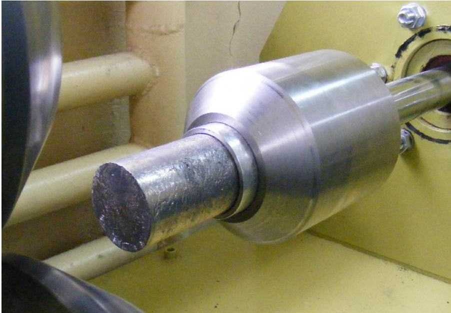
Rys. 5.2. Głowica obrotowa z wsadem w tulei prowadzącej w trakcie prób funkcjonalno – ruchowych agregatu PO-1[9]
