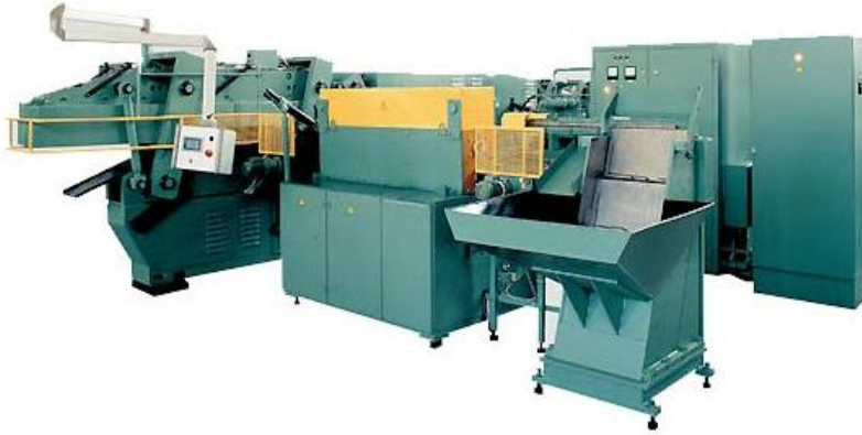
Rys. 2.21. Walcarka płaskoklinowa firmy Beltechnologia & M (Białoruś) [70]
