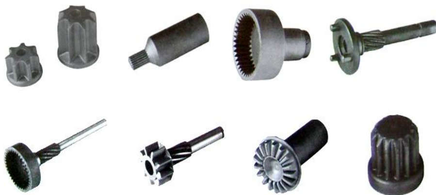
Rys. 2.15. Przykładowe elementy wykonywane metodą wyciskania na zimno [72,76]
