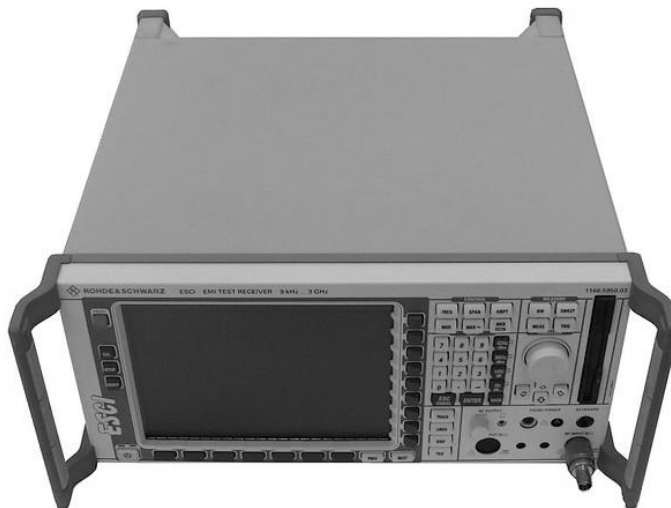
Rys. 5. Odbiornik ESCI3 firmy Rohde & Schwarz (IPEiE) (źródło: opracowanie własne)
