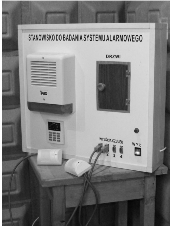
Rys. 4. Model systemu alarmowego wykorzystanego do badań (źródło: opracowanie własne)
