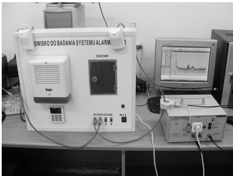
Rys. 9. Widok stanowiska badawczego do pomiaru zaburzeń przewodzonych w torze sygnałowym (centrala alarmowa – czujnik PIR) oraz w torze zasilania (źródło: opracowanie własne)
