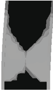
Rys. 12. Przegub plastyczny utworzony przy skrajnej podporze ramy
