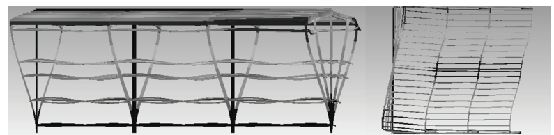
Rys. 8. Druga postać drgań własnych otrzymana w przypadku: (a) Modelu A, (b) Modelu B
