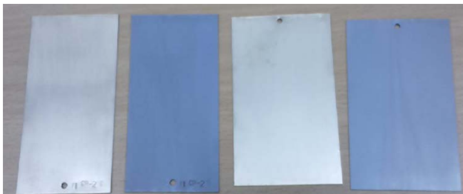
Rys. 2. Próbkki tytanowe GRADE1 i GRADE 2 poddane obróbce trawienia i anodowania
