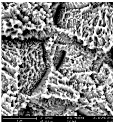
Rys.6. Powierzchnia płytki tytanowej po oczyszczeniu ultradźwiękami, SEM [opracowanie własne]
