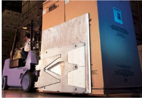
Rys. 6.16. Ścisk do kartonów [17]
