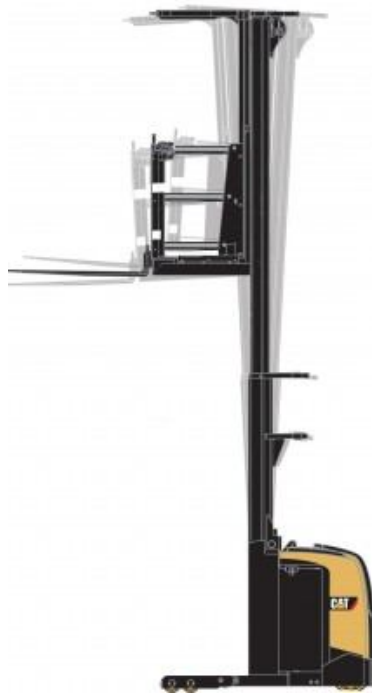
Rys. 6.24. Wizualizacja kołysania masztu wózka wysokiego składowania [43]
