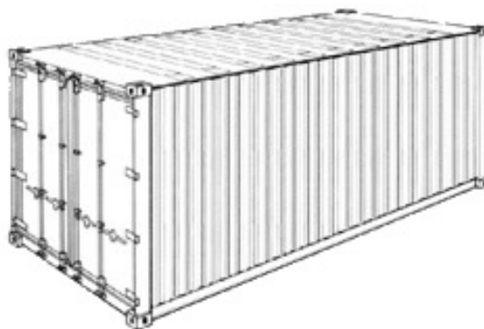
Rys. 3.22. Kontener uniwersalny drobnicowy [7]
