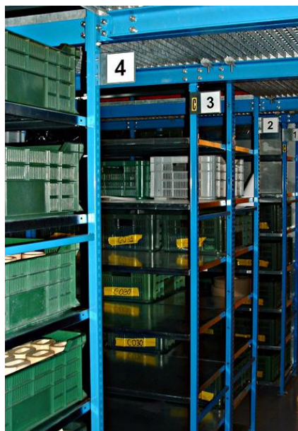
Rys. 4.2. Regal MINIRACK ze skrzynkami plastikowymi [42]
