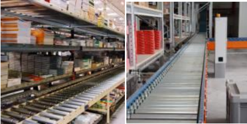
Rys. 5.4. Przenośniki wałkowe zintegrowane z regałami [30, 50]
