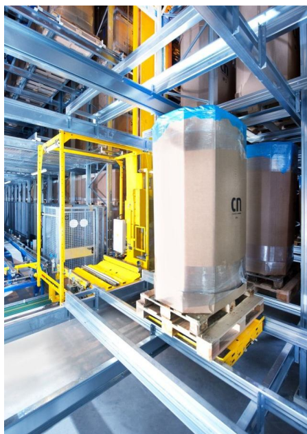
Rys. 4.9. Technologia składowania w tunelowym regale przepływowym z napędzanymi wózkami unoszącymi współpracującymi z automatyczną układnicą [11] wózek regalowy unoszący przemieszczający się po torze szynowym w tunelu regalowym, b- odbiór ładunku z wózka unoszącego na automatyczną układnicę
