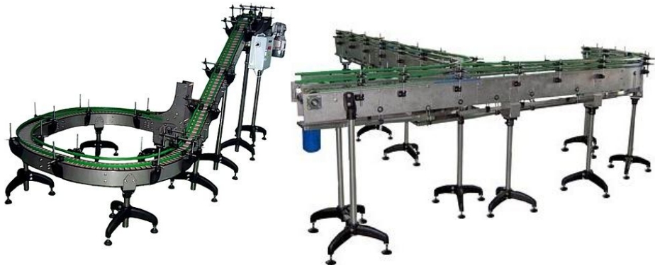
Rys. 5.14. Przykłady zastosowania przenośników płytkowych [47]
