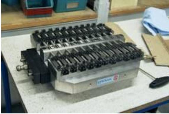
Rys. 3.31. Paleta przedmiotowa przystosowana do transportu serii detali przeznaczonej do obróbki [36]
