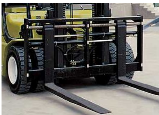
Rys. 6.13. Zintegrowany przesuw i pozycjoner widel [17]
