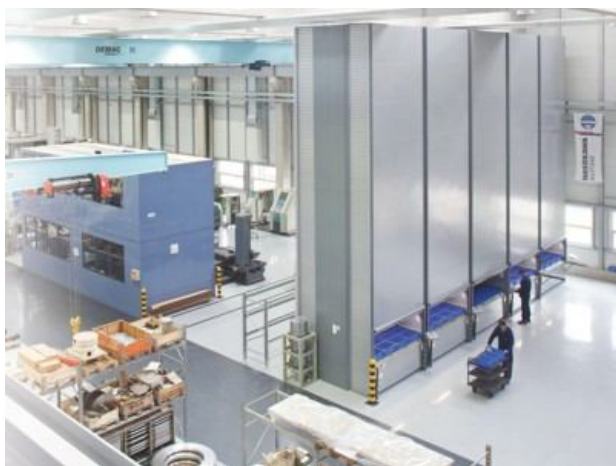
Rys. 4.27. Zastosowanie regalów windowych jako miejsc tymczasowego składowania [39]
