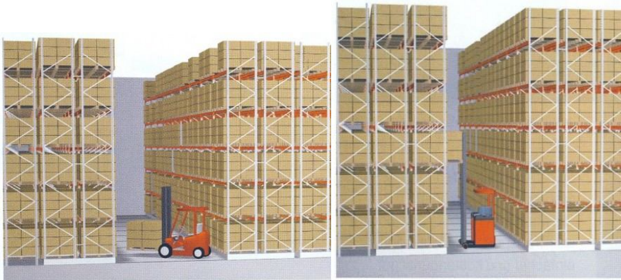
Rys. 9.7. Regały przejezdne torowe napędzane ramowe pracujące w układzie równoległym obsługiwane wózkami podnośnikowymi: a – czołowym, b – z wysuwным masztem. [25]
