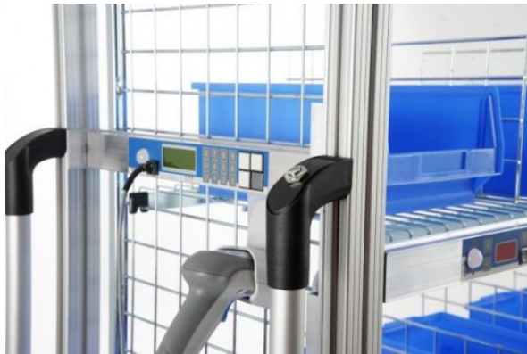
Rys. 8.6. Nośny element regalowy z panelem Pick-by-Light [29]
