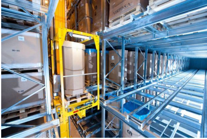
Rys. 9.10. Regał przepływowy w układzie bloku regalowego z wózkami satelitarnymi, windą wyciągową i wózkiem kondygnacyjnym - System Orbiter firmy SSI Schäfer [26]
