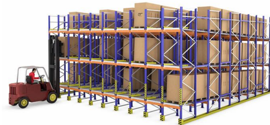
Rys. 4.6. Technologia składowania palet w regale przepływowym [51]
