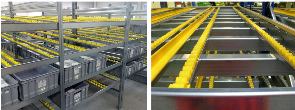
Rys. 4.15. Powiązanie układu transportowego z regałami przeplywowymi [51]
