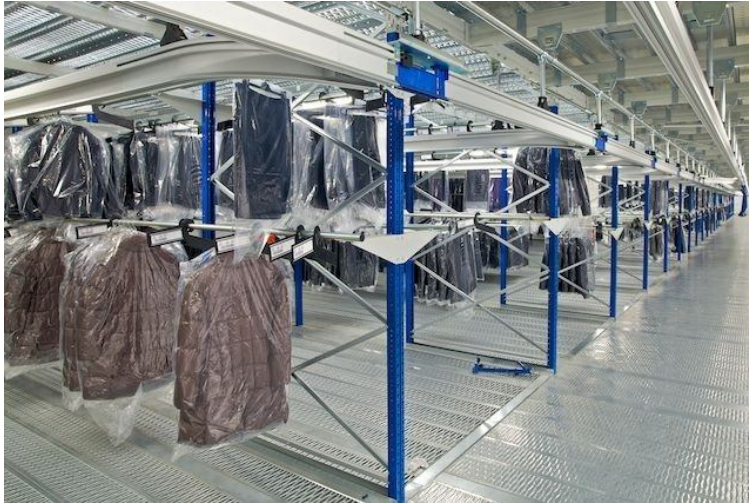
Rys. 5.17. Zastosowanie transportu podwieszanego w hurtowni odzieżowej [43]
