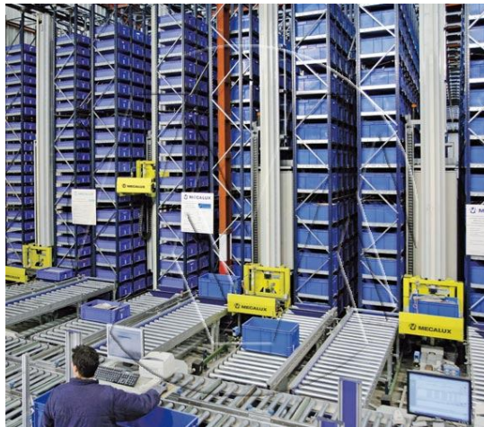
Rys. 7.8. Układ automatycznego składowania pojemników w regale za pomocą układnicy pojemnikowej [26]
