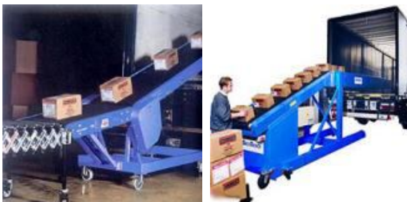
Rys. 5.19. Przenośniki teleskopowe stałe w zastosowaniach wewnątrz i zewnątrz magazynu [17]
