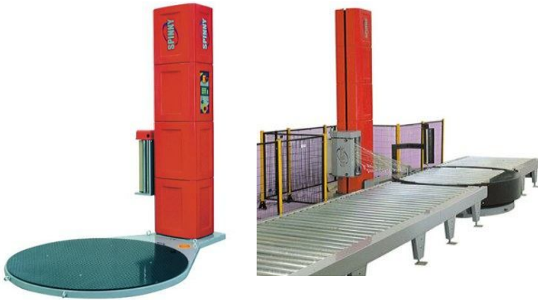
Rys. 5.32. Owijarka: a – widok ogólny urządzenia, b – owijarka wbudowana w linię transportową [39]
