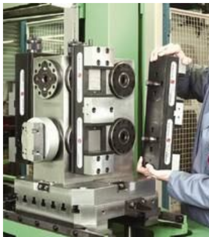
Rys. 3.30. Elementy integracyjne w ESP: a - układ modułowy stanowiący zestaw palet przedmiotowych zamontowanych na palecie transportowej, b – składowanie modułów w magazynach regałowych [45]
