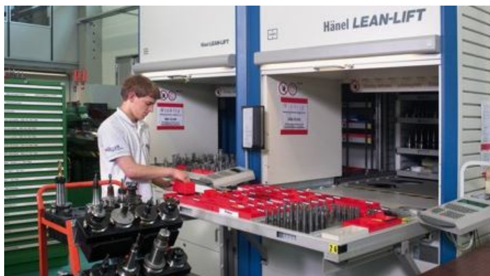
Rys. 4.25. Regał windowy przeznaczony do magazynowania narzędzi skrawających [39]
