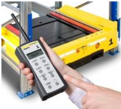
Rys. 4.30. Bezprzewodowy układ sterowania ruchem Orbitera [26]
