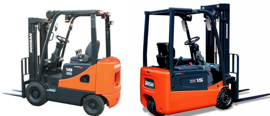
Rys. 6.1. Wózek z napędem a- spalinowym, b- elektrycznym [17]
