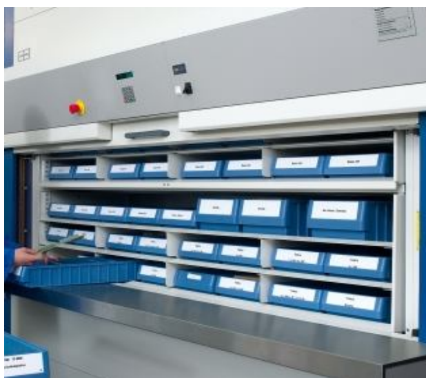
Rys. 4.22. Regał okrężny o ruchu pionowym: widok ogólny oraz widok na otwór operacyjny [39]
