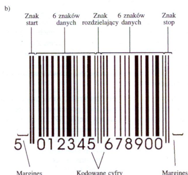
Rys. 11.14. Struktura kodu kreskowego EAN-13 [4]
