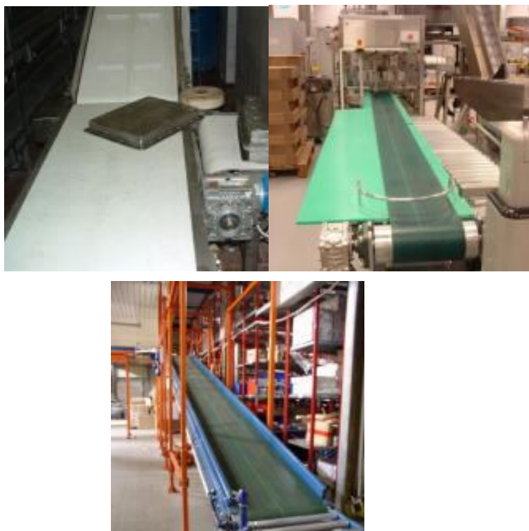
Rys. 5.12. Typowe rodzaje przenośników taśmowych płaskich [31, 54]
