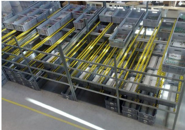
Rys. 4.15. Powiązanie układu transportowego z regałami przeplywowymi [51]
