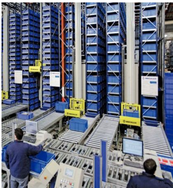
Rys. 8.4. Przykład systemu kompletacji dynamicznej wykorzystujący system AS/RS w wersji „mini load” [29]
