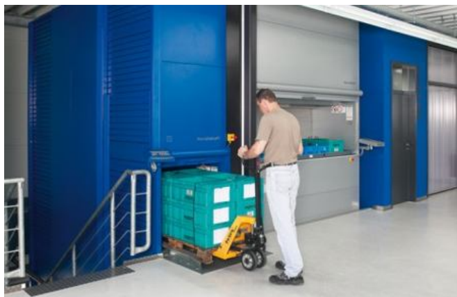
Rys. 4.26. Składowanie jednostek paletowych w regale windowym [39]
