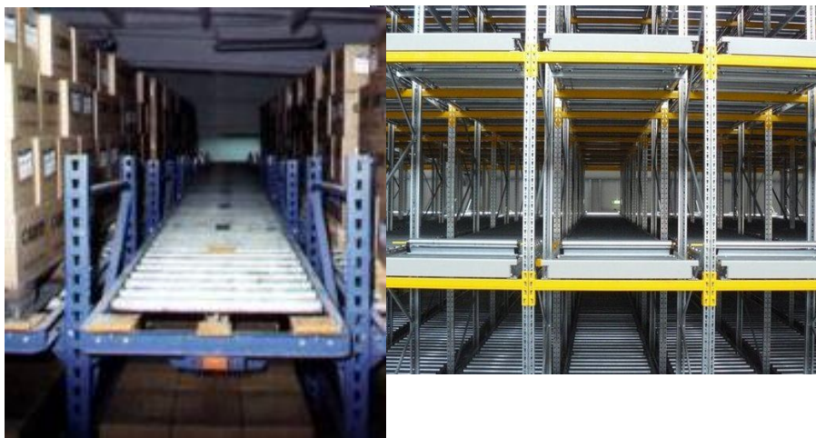
Rys. 4. 7. Regaly przepływowe walkowe [28]
