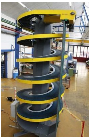
Rys. 5.27. Transporter spiralny do lekkich produktów [33]
