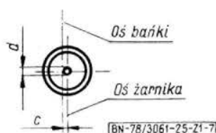
Rys. Z1-7. Wzajemne położenie osi bańki i osi żarnika
