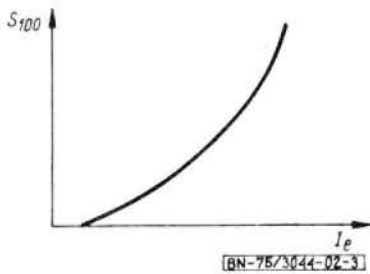
Rys. 3. Zależność liczby szwów od prądu probierczego (przy N = \text{constans} cykli łączeniowych)
