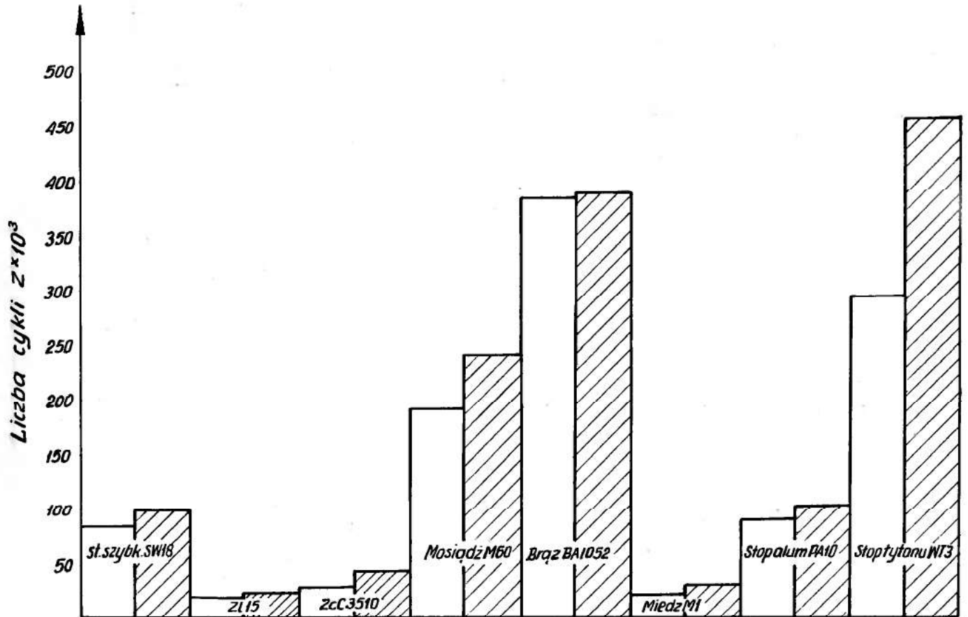
Rys. 65 Porównanie wytrzymałości zmęczeniowej różnych materiałów (wyż. i odpr.) poddanych i nie poddanych obróbce powierzchniowej zgniotem. War. obróbki: \phi_k = 6,3 \text{ mm} , v = 60 \frac{\text{m}}{\text{sek}} , t = 10 \text{ min} , A = 2,15 \text{ mm} ▨ - materiał poddany zgniotowi □ - materiał nie poddany zgniotowi
