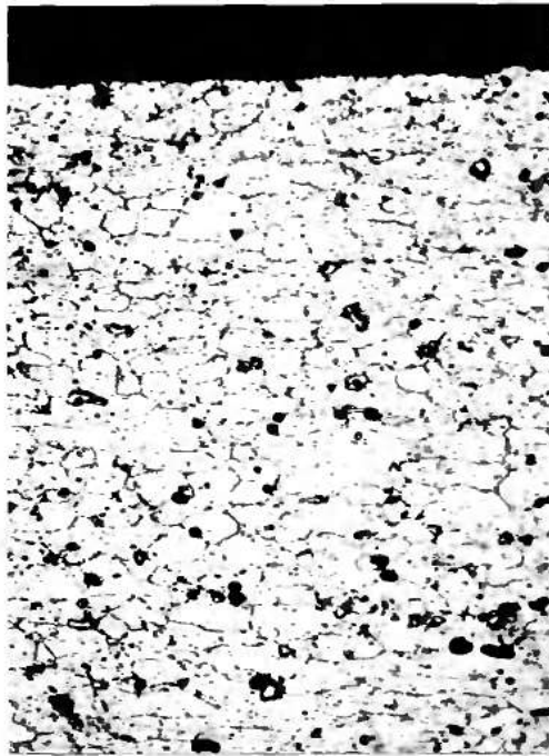
Rys.52 z Mikrostruktura warstwy wierzchniej stopu alum. PA10 (przesyc.i starz.) po obróbce zgniotem. War. obróbki: \dot{\nu}=60 \frac{1}{sek} , t=10min , A=2,15mm , \Phi_k=6,3mm
