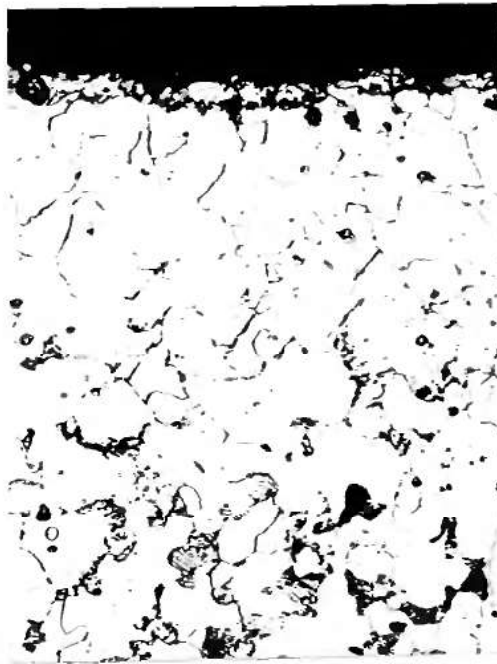
Rys 40 z Mikrostruktura warstwy wierzchniej stali 15 (wyż. i odpr.) po obróbce zgniotem War. obróbki: \dot{V}=60\frac{1}{sek} , t=10min , A=2,15mm , \Phi_k=5,3mm
