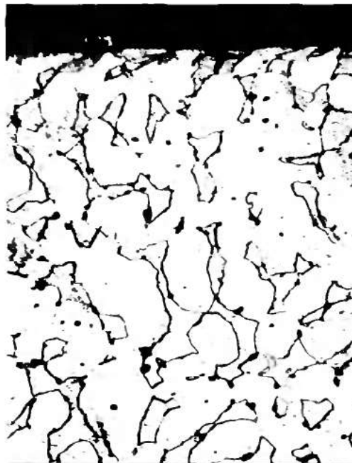
Rys.55 z Mikrostruktura warstwy wierzchniej mosiądzu M60 (wyż. i odpr.) po obróbce zgniotem. War. obróbki: v=60\frac{1}{sek} , t=10min , A=2,15mm , \Phi_k=6,3mm
