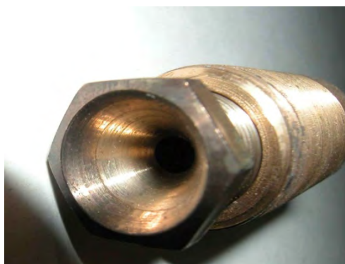
Rys. 74. Wygląd fragmentów instalacji do natryskiwania emulsji: a) końcówka dyszy (w powiększeniu), b) wygląd przebiegu natryskiwania emulsji na wewnętrznej powierzchni kanału z transparentnego tworzywa polimerowego
