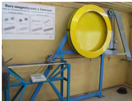
Rys. 20. Wygląd stanowisk do badań wzajemnego oddziaływania kabla z kanałem: a) na odcinku prostoliniowym, b) na łukach kołowych i odcinkach krzywoliniowych [41, 197]
