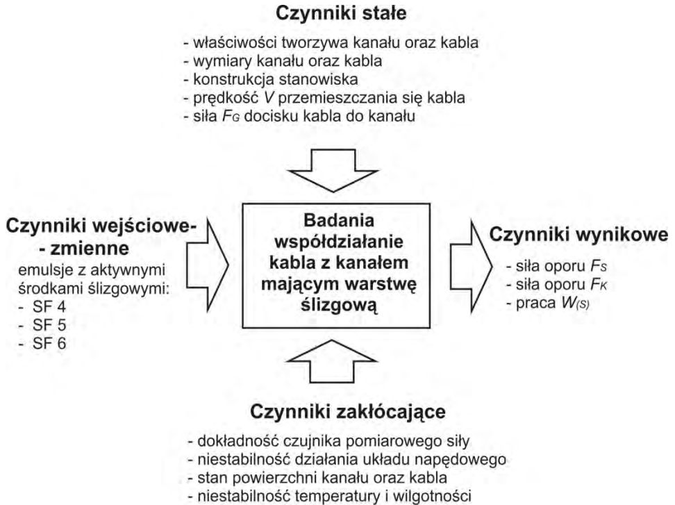
Rys. 79. Diagram przedstawiający czynniki uwzględnione w badaniach wzajemnego współdziałania kanału mającego warstwę ślizgową z kablem optotelekomunikacyjnym
