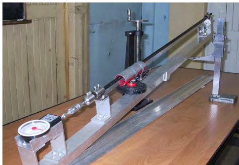
Rys. 20. Wygląd stanowisk do badań wzajemnego oddziaływania kabla z kanałem: a) na odcinku prostoliniowym, b) na łukach kołowych i odcinkach krzywoliniowych [41, 197]
