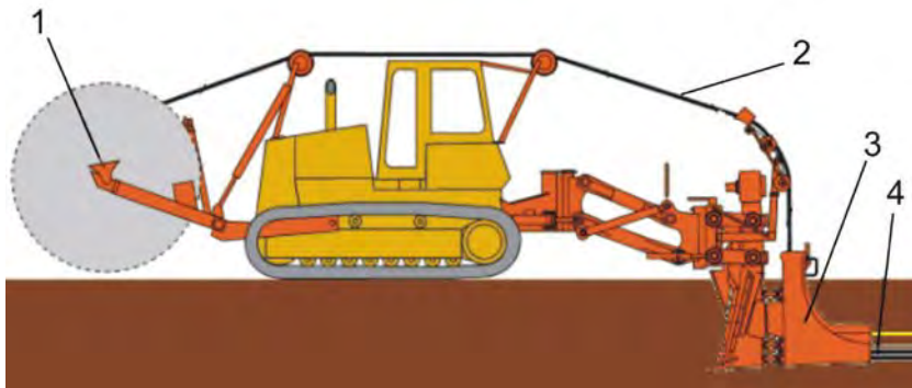
Rys. 16. Schemat przykładowego urządzenia do układania kanału z tworzywa polimerowego bezpośrednio w glebie: 1 – bęben, 2 – kanał, 3 – układ do kształtowania wgłębienia w glebie, 4 – ułożony odcinek kanału [161]
