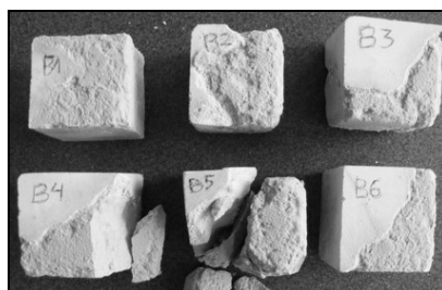
Fot.9.20 Próbki strefy B po 2 cyklu zasolenia w roztworze 14 % siarczanu sodu
