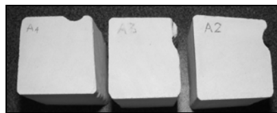
Fot.9.26 Próbki strefy A po 15 cyklach zasolenia w roztworze 14 % chlorku sodu
