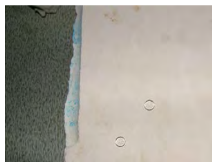
Fot. 9.4 Próbką III 6. badanie skuteczności hydrofobizacji metodą absorpcji kropli wody
