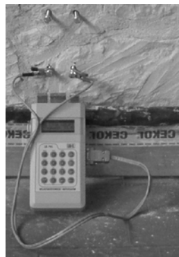
Fot. 10.11 Pomiar wilgotności miernikiem LB-795
