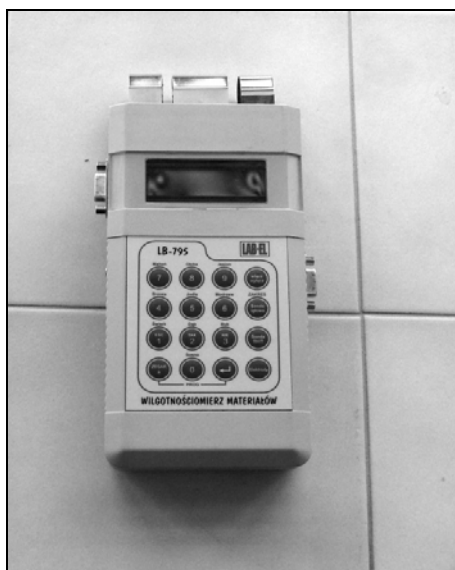
Fot. 3.10 Wilgotnościomierz dielektryczny LB-795
