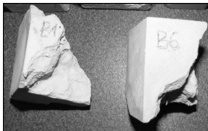
Fot.9.21 Próbki strefy B po 15 cyklu zasolenia w roztworze 14 % siarczanu sodu
