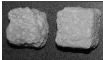
Fot.9.24 Próbki strefy C po 10 cyklu zasolenia w roztworze 14 % siarczanu sodu
