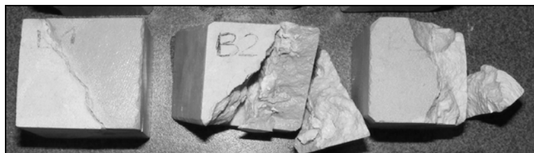
Fot.9.33 Próbkki strefy B po 9 cyklach zasolenia w roztworze 14 % azotanem sodu
