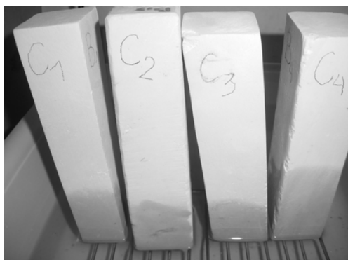
Fot. 9.13 Badanie kapilarnego podciągania opoki strefa C po godzinie badania
