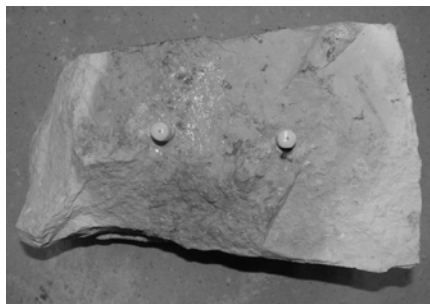
Fot. 10.2 Blok opoki po procesie tłoczenia preparatu II. Widok z góry
