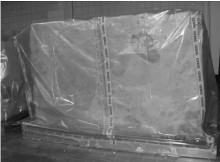
Fot. 10.8 Widok muru w kołnierzu podczas procesu karbonizacji
