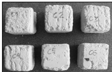
Fot.9.23 Próbki strefy C po 2 cyklu zasolenia w roztworze 14 % siarczanu sodu
