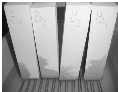
Fot. 9.12 Badanie kapilarnego podciągania opoki strefa B po godzinie badania
