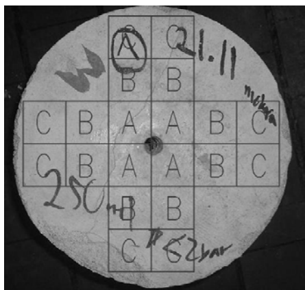
Fot. 9.38 Próbką zaprawy wapiennej z podziałem na strefy
