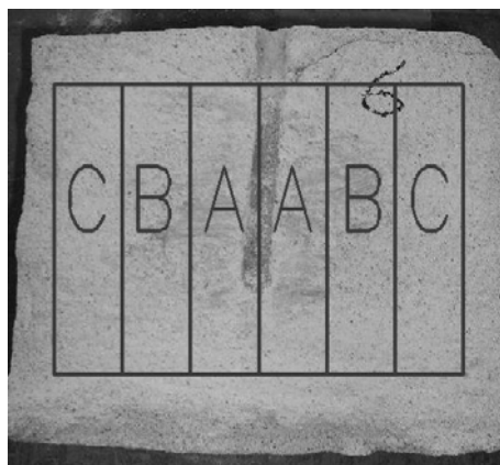
Fot. 9.39 Rozkład stref poboru próbek z walca hydrofobizowanej zaprawy wapiennej
