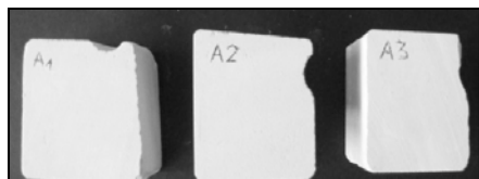
Fot.9.25 Początkowy stan próbek strefy A przed zasoleniem chlorkiem sodu
