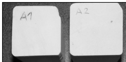
Fot.9.31 Próbkki strefy A po 15 cyklach zasolenia w roztworze 14 % azotanem sodu
