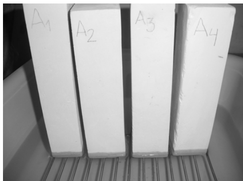
Fot. 9.11 Badanie kapilarnego podciągania opoki strefa A po godzinie badania
