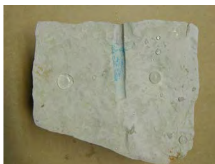
Fot. 9.3 Próbką II 10. Widoczny efekt hydrofobizacji na powierzchni przecięcia.
