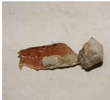
Fot. 9.2 Czop z krzemianu modyfikowanego silikonem wyjęty z otworu.
