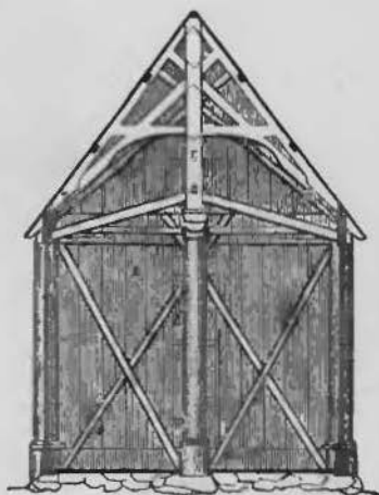
Rys. 604. Przekrój poprzeczny kościoła z Norwegji we Flaa. Wiek XIII. (Kolo Chrystjanji).
