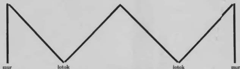
Rys. 783. Szkic dachu czteropoliaciowego, pogrążonego.
