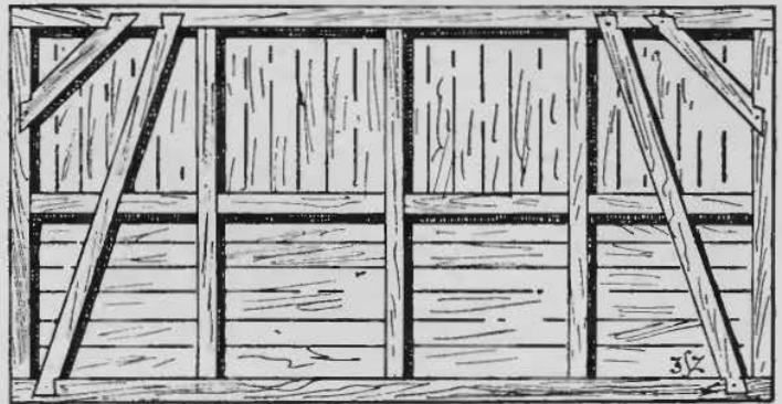
Rys. 100. Stodoła o czterech przeszłach z dwóch czwartaków. Środkim słup przecina się w krzyż z rozpórą. W przeszłach skrajnych zastrzały strome i miecze równoramienne.
