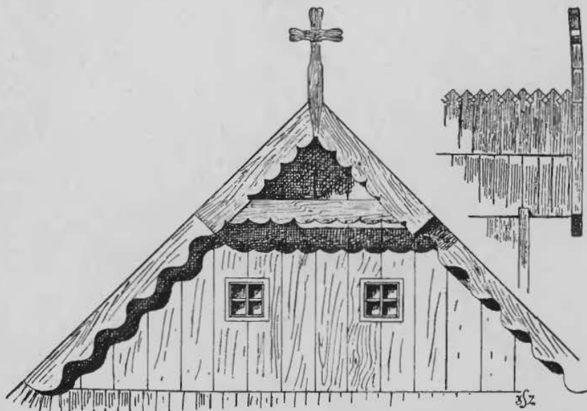
Rys: 189. Szczytnica z nadwieszką, która jest zwieńczona krzyżem. Z domu w Zawoju. Dwa okienka strychowe w kątomir.
