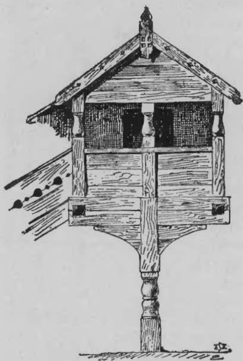
Rys: 136. Z budownictwa drewnianego wschodniego. Przykład osobliwy ganeczku na 1 stopie założonego, wedle dwudziału polskiego. (Z dzieła: „Ih. Hrabara“ przy chatach zwanych „izba czarna“.
