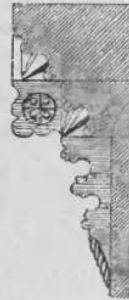
Rys: 297. Nadwieszenie belek piętrowych z dodaniem wsporników. Kołomir łęchicki na belce w przekroju. (Halberstadt w Prusiech).
