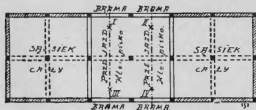
Rys. 97. Rzut poziomy stodoły założonej na 21. słupach, z dwoma sąsiedkami całymi i z klepiskiem cztró-bramnym, w czwartaku umieszczonym.
