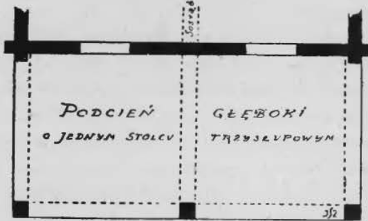
Rys: 26. Podcień głęboki „dwudzielny“ o trzech słupach.
