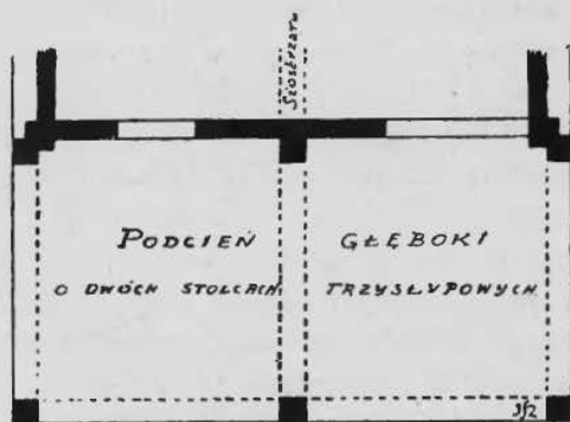
Rys: 28. Podcień głęboki z przyłapem w głębi wedle „dwudziału“. —
