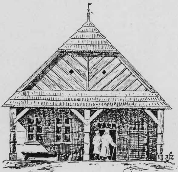
Rys: 49. Dom podcieniowy o dwóch krzesłach, z przystrzęskiem górnym i dolnym. (Ciężkowice nad Białą).
