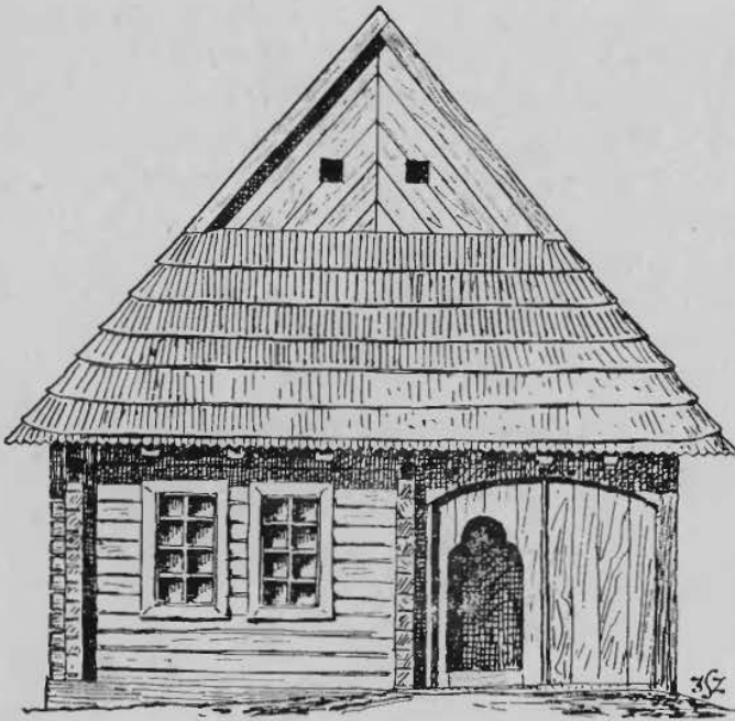
Rys: 288. Dom stary w Nowotargu na zasadzie dwudziału. W części większej świetlica, w części mniejszej brama i ściana przejezdna.
