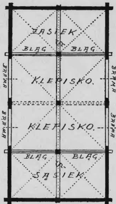
Rys: 13. Rzut poziomy stołowy, założonej na dwóch czwartakach, czterodzielnych.
