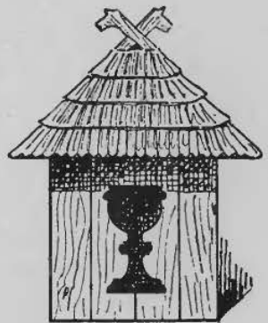
Rys: 194. Okienko strychowe jako dymnik ze Żubrzyce Wyżniej. Kielich znakiem naczynia duchownego.
