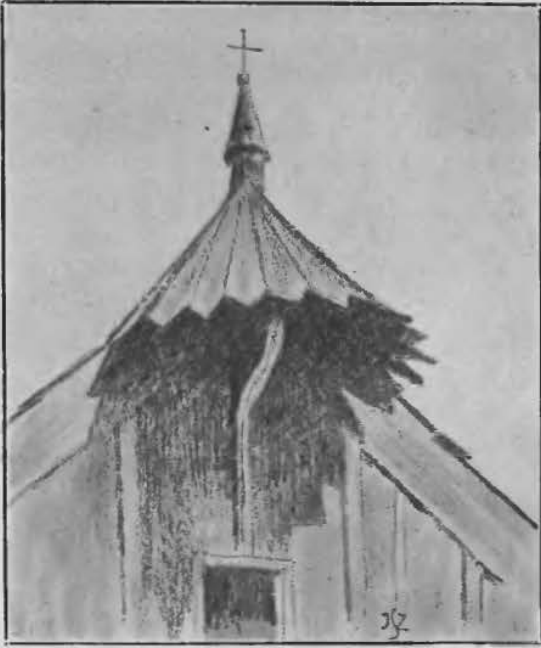
Rys: 229. Ostrzeszek z okapem na półkolu zatoczonym z dziadkiem czyli ptasznikiem (lub pazdurem), na którym krzyż z kulą (Zawoja Wilezna — chata nad potokiem).
