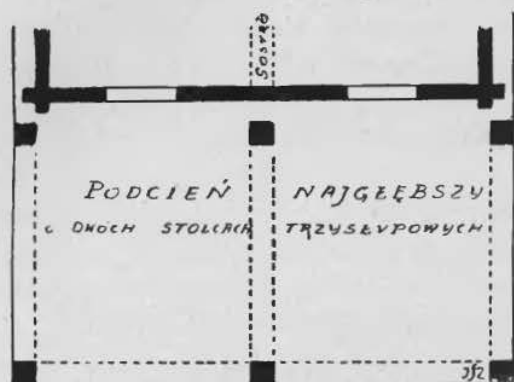
Rys: 27. Podcień najgłębszy z przyzbą w głębi — na zasadzie „dwudziału“.
