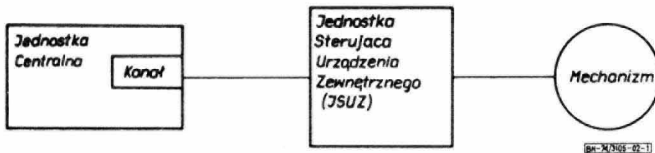
Rys. 1. Kanał pojedynczy i urządzenie jednomechaniz-mowe
