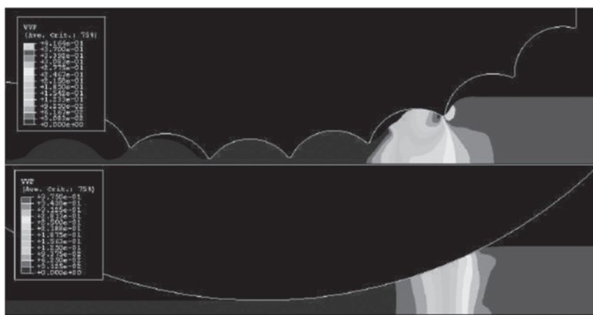
Rys. 19. Rozkład stopnia zagęszczenia materiału w procesach brykietowania i kompaktowania [Zavaliangos i in. 2003]
