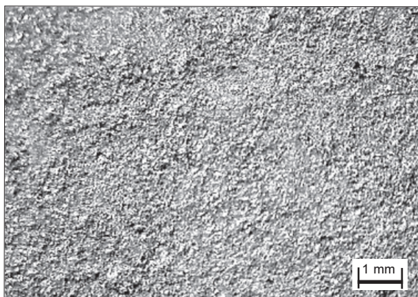
Rys. 41. Struktura brykietu wykonanego z materiału bez dodatków wiążących (fot. G. Borowski)
