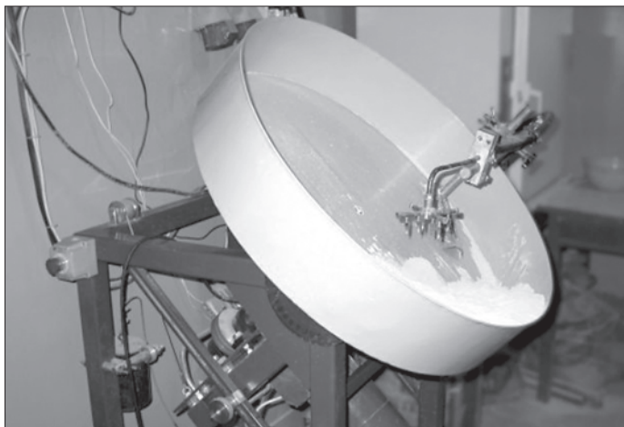
Rys. 28. Granulowanie na talerzu granulacyjnym (fot. G. Borowski)
