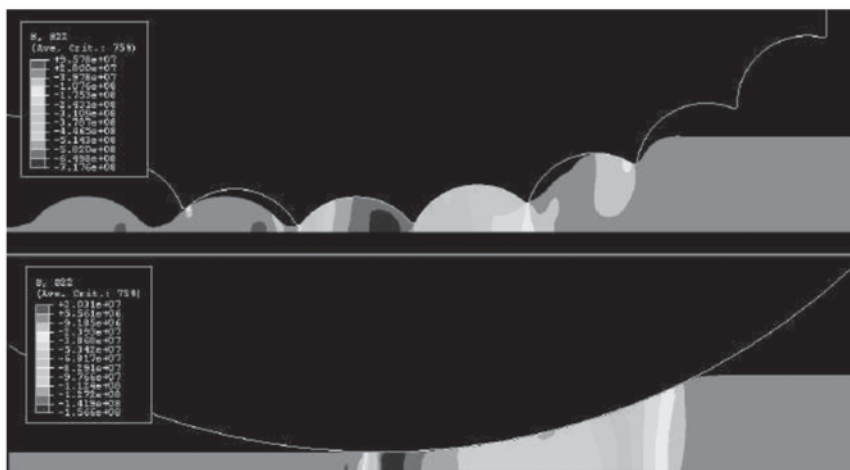
Rys. 20. Rozkład naprężeń poprzecznych w procesach brykietowania i kompaktowania [Zavaliangos i in. 2003]
