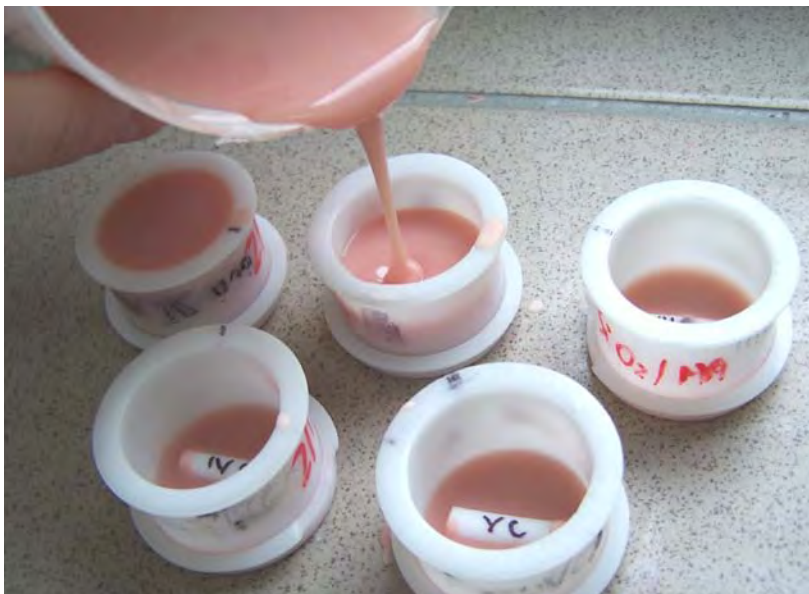
Rys. 6.2. Przygotowanie próbek w postaci zglądów poprzez zalanie tworzywem akrylowym chemoutwardzalnym
