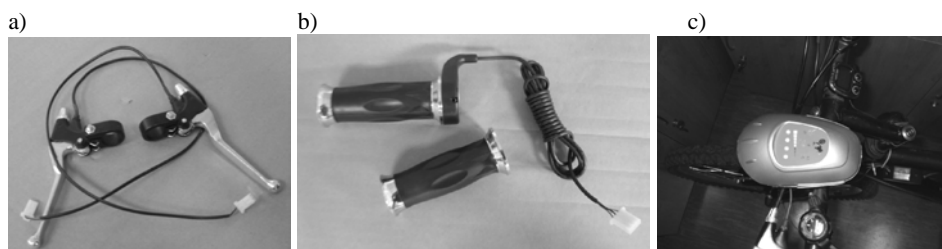
Rys. 7. a) Hamulec elektryczno-mechaniczny silnia; b) Regulator prędkości; c) Wskaźnik naładowania baterii
