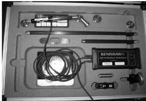
Rys. 3. Zestaw diagnostyczny obrabiarek CNC Q10 Ballbar
