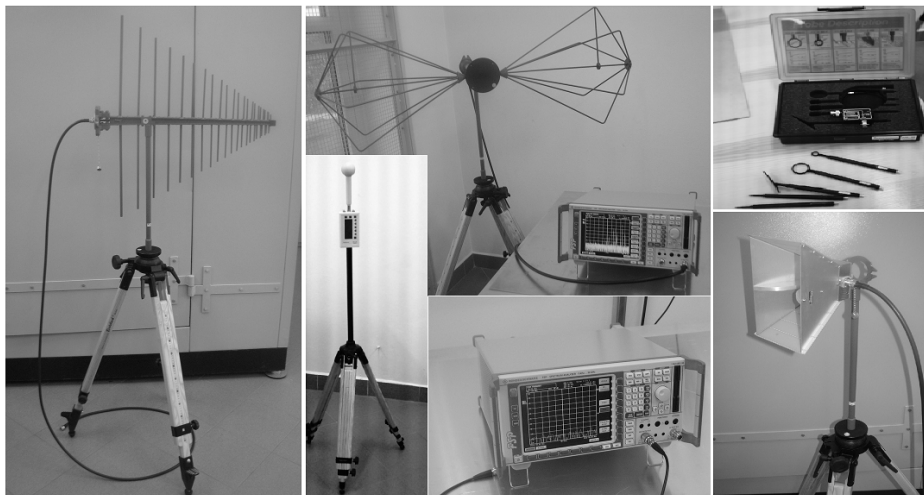
Rys. 2. Zdjęcia aparatury pomiarowej do badania emisji promieniowanej na wyposażeniu Laboratorium Kompatybilności Elektromagnetycznej na Politechnice Lubelskiej (zestaw firmy Rohde&Schwarz oraz Maschek)
