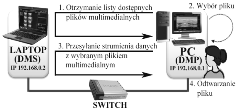
Rys. 3. Schemat domowej sieci multimedialnej typu 2 box pull
