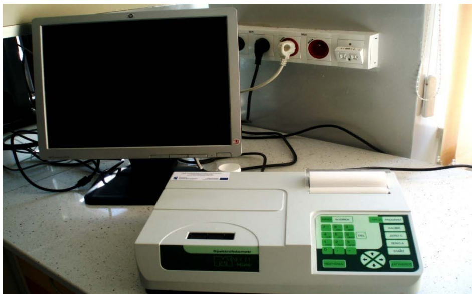
Fot. 7. Stanowisko spektrofotometryczne oznaczania stężenia jonów w roztworze z wyznaczonym stałym współczynnikiem nachylenia krzywej kalibracyjnej dla poszczególnych jonów.
