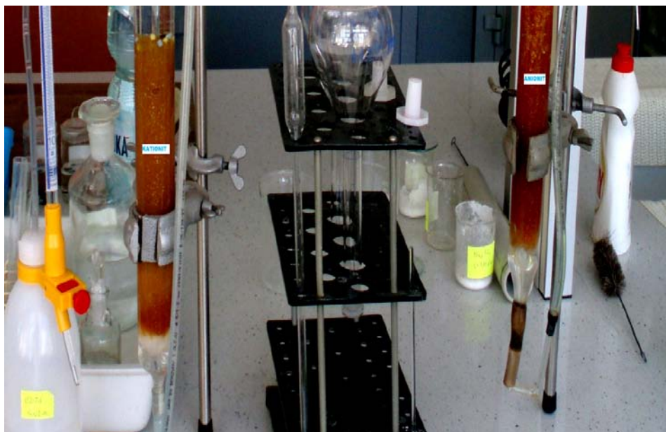
Fot.6 Stanowisko przedstawia dwie kolumny: wypełnioną żywicą jonowymienną stanowiącą kationit z grupą funkcyjną RSO 3 H (po lewej) i anionit z masą żywiczną z grupą funkcyjną RNR' 3 OH (po prawej); R - oznacza strukturalną jednostkę jonitu, R' - np. CH 3
