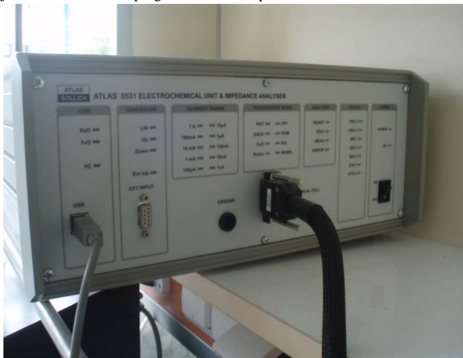
Fot. 7. Potencjostat – układ elektrochemiczny do pomiaru polaryzacji metali metodą potencjostatyczną.
