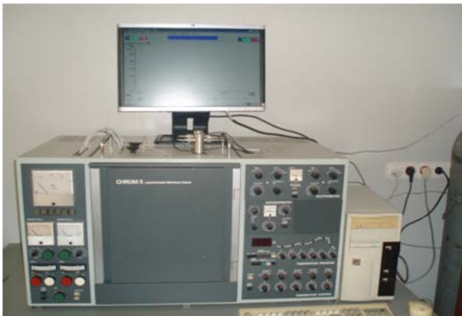
Fot. 10. Stanowisko chromatograficzne doświadczalne z oprogramowaniem komputerowym Chrom2010 . Analiza ilościowa substancji organicznych
