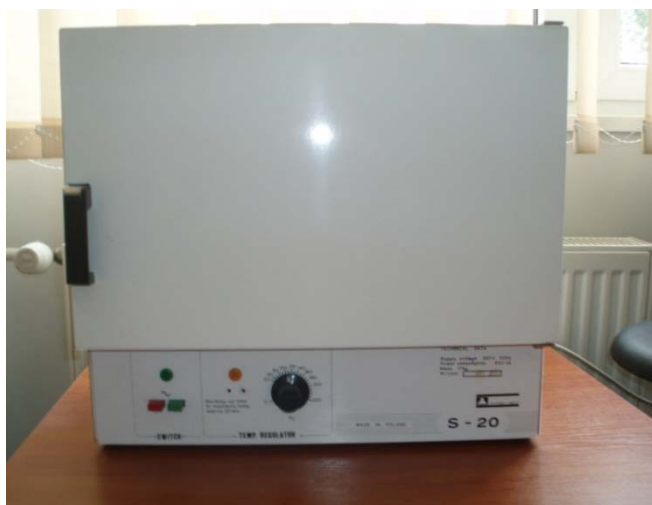
Fot. 4. Suszarka laboratoryjna z naturalnym obiegiem powietrza.
