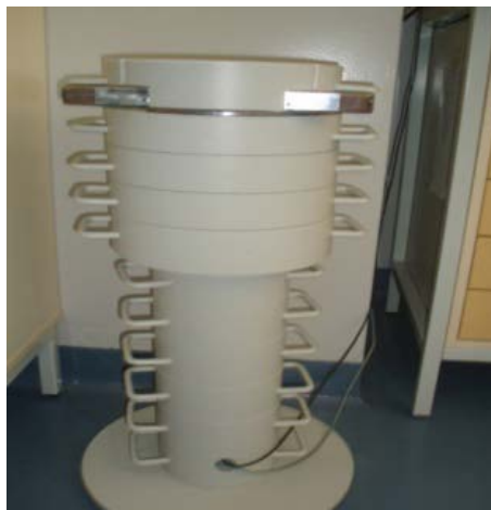
Fot. 11. Stanowisko pomiarowe do pomiaru stężenia promieniowania \gamma izotopów K 40 , Ra 226 , Th 226 będących podstawowym źródłem promieniotwórczości naturalnej materiałów budowlanych ( po prawej domek osłonowy)
