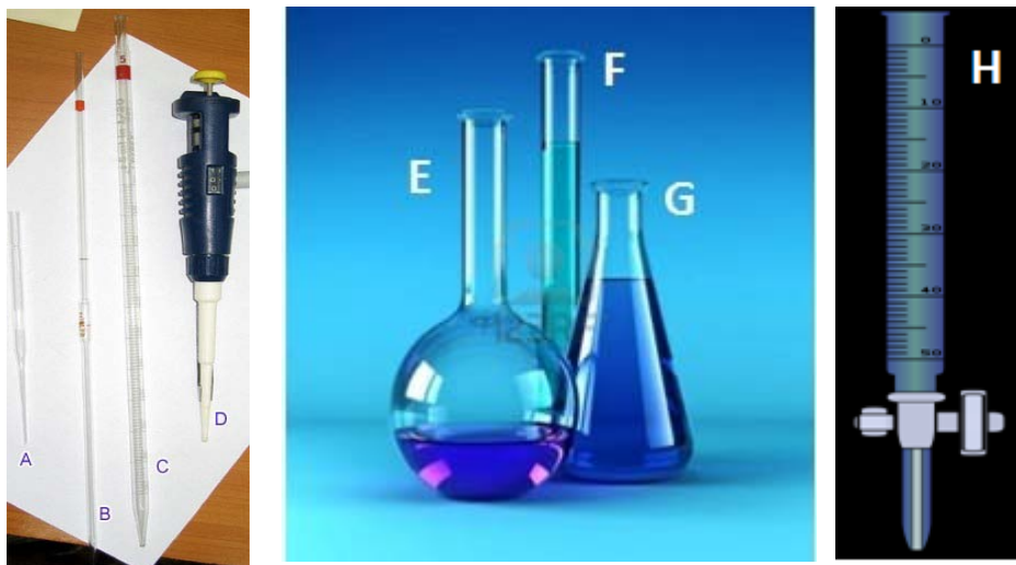
Fot. 2. Naczynia miarowe: Pipety: A) Pasteura, B) jednomiarowa, C) wielomiarowa, D) pipeta automatyczna; E) kolba miarowa; F) cylinder Nesslera, G) kolba stożkowa, H) biureta.
