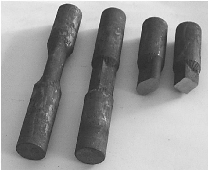
Rys. 2.26. Odkuwki ze stopniami kształtowymi (owalnym i kwadratowym) otrzymane w laboratoryjnych próbach walcowania
