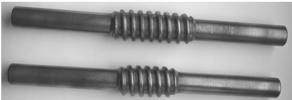
Rys. 7.33. Widok odkuwek ze ślimakami otrzymanych w procesie walcowania z wsadów nagrzewanych w nagrzewnicy indukcyjnej NG-430
