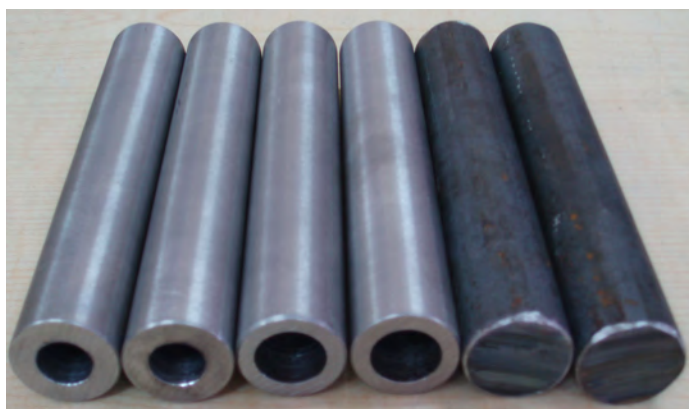
Rys. 2.21. próbki ze stali w gatunku C45 wykorzystane w badaniach doświadczalnych
