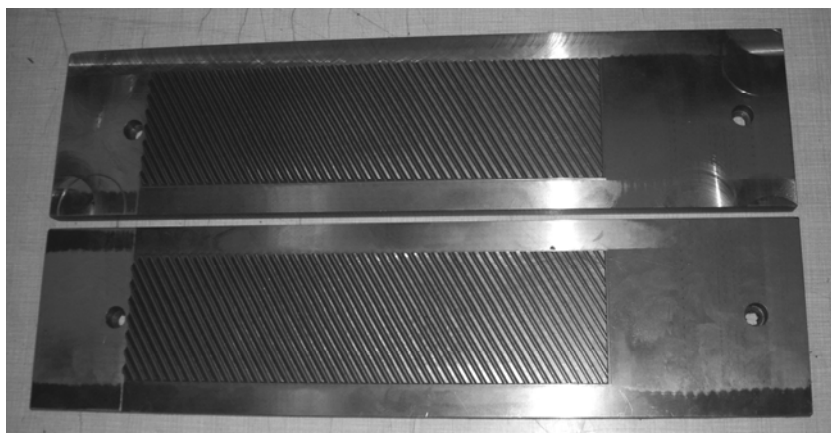
Rys. 6.42. Narzędzia zastosowane w próbach walcowania uzębienia skośnego o module m=2 i pochyleniu linii zęba 30^\circ
