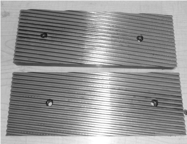
Rys. 7.26. Szczęki narzędziowe wykorzystane w badaniach doświadczalnych, realizowanych w zakresie kształtowania uzwojenia ślimaka jednokrotnego o wysokości h=3,0 mm
