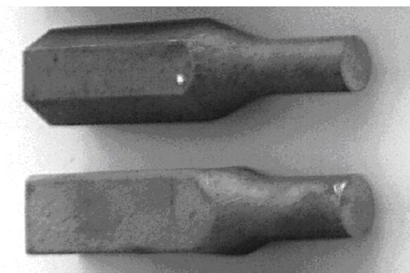
Rys. 4.7. Próbki ze stali C45 odwalcowane w procesie WPK, z wykorzystaniem wsadu o przekroju poprzecznym sześciokątnym i kwadratowym (pokazano ½ próbek)
