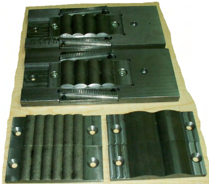
Rys. 3.6. Zestawy narzędziowe wykorzystane w procesach WP odkuwek o przekroju poprzecznym różnym od kołowego
