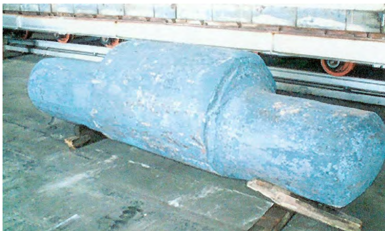
Rys. 5.1. Wał mimośrodowy dużych rozmiarów ukształtowany metodą kucia swobodnego
