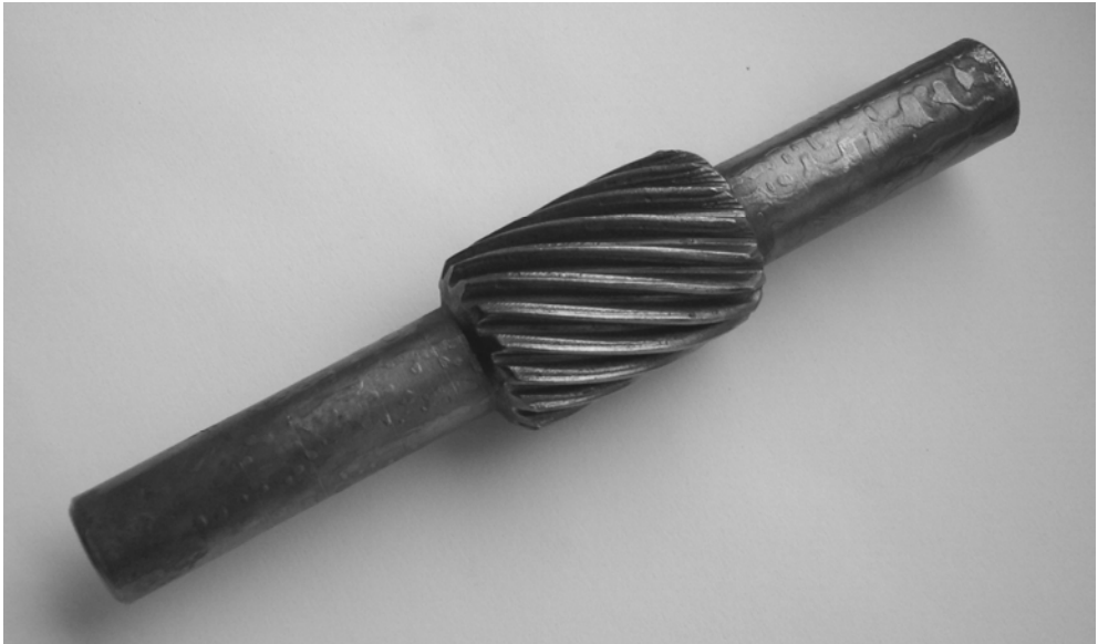
Rys. 6.46. Wałek z odwalcowanym uzębieniem skośnym, po wystygnięciu i oczyszczeniu ze zgorzeliny
