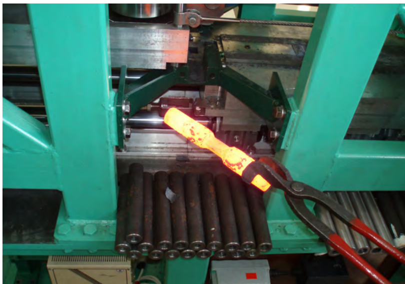
Rys. 2.24. Odkuwka ze stopniem o przekroju poprzecznym w kształcie kwadratu wyjęta z podajnika walcarki LUW-2
