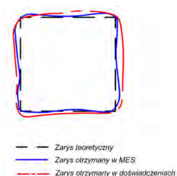
Rys. 2.32. Porównanie otrzymanych zarysów przekroju poprzecznego odkuwki ze stopniem kwadratowym
