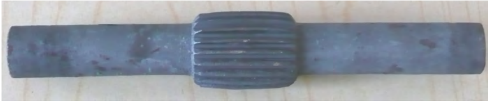
Rys. 6.38. Wieniec zębaty (o długości 30 mm) odwalcowany na wałku, w efekcie wykonanych prób laboratoryjnych
