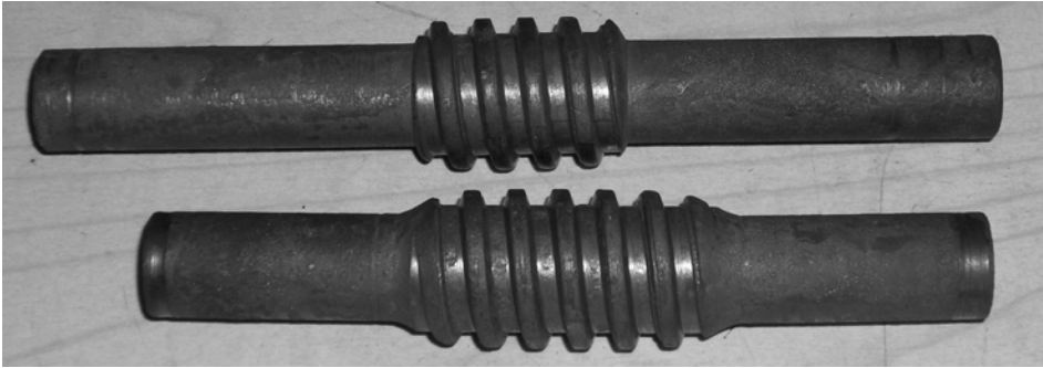
Rys. 7.29. Przykłady odkuwek, ze ślimakami otrzymanymi proponowaną metodą walcowania poprzecznego szczękami płaskimi
