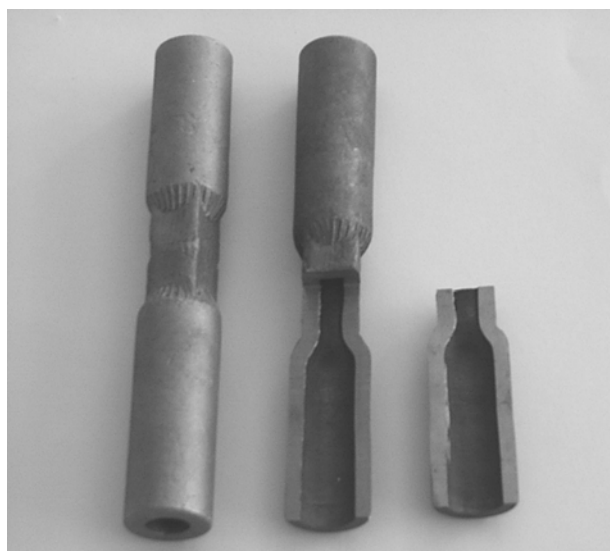
Rys. 2.27. Odkuwki o przekroju poprzecznym kwadratowym, odwalcowane z wsadu drążonego
