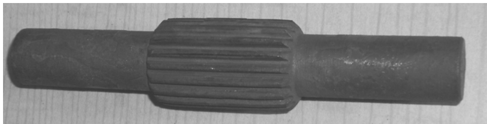
Rys. 6.40. Wieniec zębaty (o długości 60 mm) odwalcowany w walcierce laboratoryjnej LUW-2
