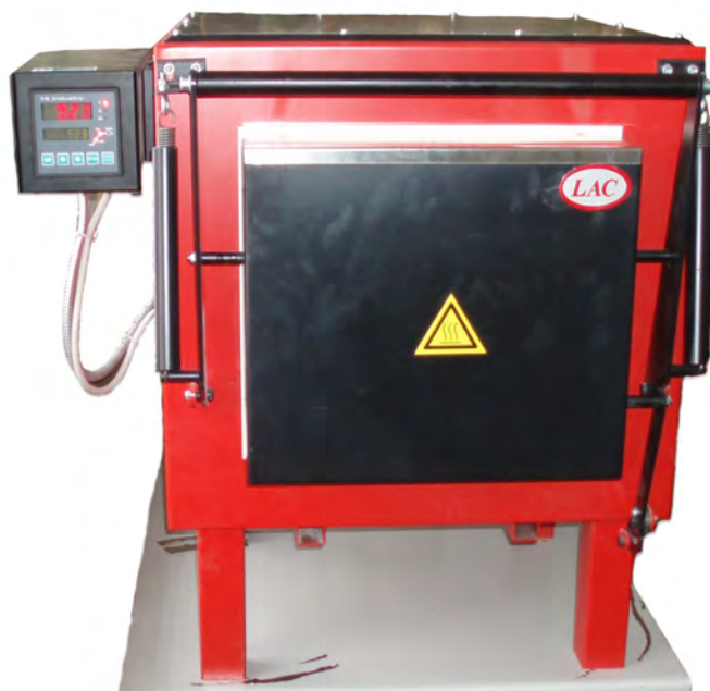
Rys. 2.16. Piec elektryczny komorowy, wykorzystany do nagrzewania próbek w trakcie badań doświadczalnych, dotyczących kształtowania (metodą WPK) wyrobów o przekroju poprzecznym różnym od kołowego
