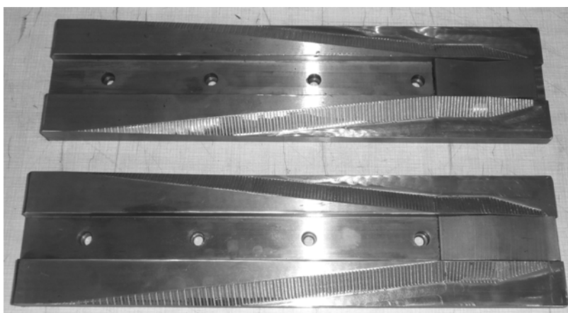
Rys. 5.23. Widok narzędzi wykonanych w celu sprawdzenia możliwości kształtowania metodą WPK wałka ze stopniem mimośrodowym, charakteryzowanym wartością ramienia mimośrodu e=2,5 mm
