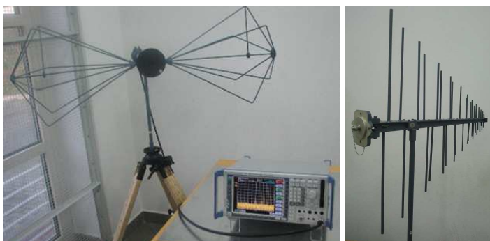
Rys. 1.1. Analizator FSP30 Rohde & Schwarz (9kHz-30GHz) z anteną dwustożkową, zdjęcie anteny logarytmiczno periodycznej (wyposażenie laboratorium EMC)
