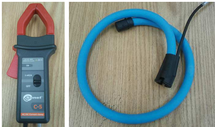
Rys. 2.2. Zdjęcie cęgów C-5 oraz cęg giętkich współpracujących z PQM-700
