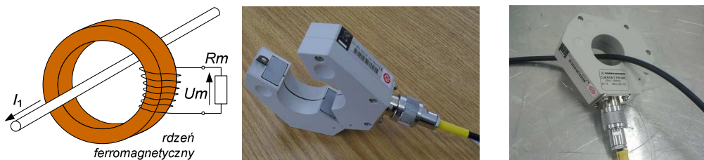
Rys. 1.3. Konstrukcja sondy prądowej oraz zdjęcia sondy EZ-17
