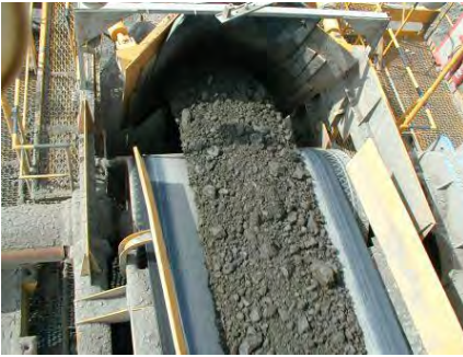
Rys. 1.1 - Przykładowe zastosowania transportu przenośnikowego [196]: a) transport materiału skalnego, b) przenośnik taśmowy jako element rozbudowanego szeregowego systemu transportowego
