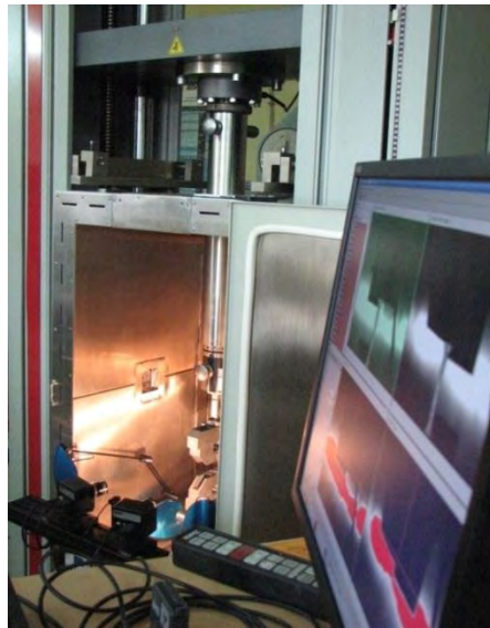
Rys. 4.5 - Stanowisko do badań wytrzymałościowych: a) – próbka podczas rozciągania, b) widok ogólny stanowiska
