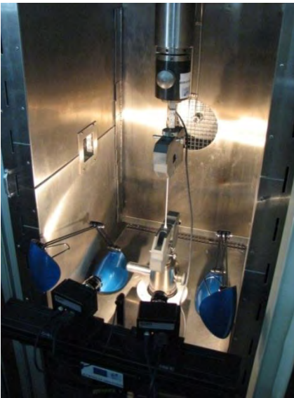
Rys. 4.5 - Stanowisko do badań wytrzymałościowych: a) – próbka podczas rozciągania, b) widok ogólny stanowiska
