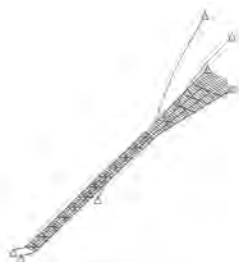
Rys. 7.50. Piąta postać drgań własnych f_5 = 2.163\text{Hz} .
