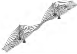
Rys. 7.92. Piąta postać drgań własnych f_5 = 0,578\text{ Hz} .
