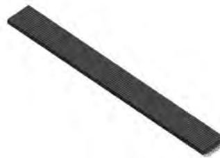
Rys. 6.32. Model MES płaskownika z nakładką drewnianą
