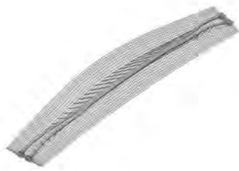
Rys. 7.97. Trzecia postać drgań własnych f_3 = 0,891\text{Hz} .
