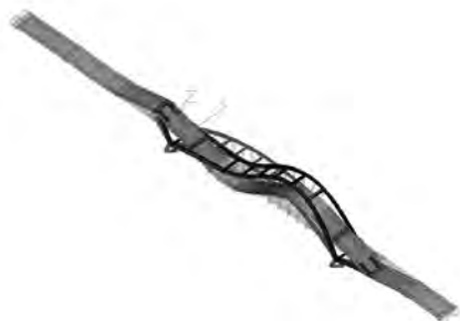
Rys. 7.64. Pierwsza postać drgań własnych f_1 = 0.6760\text{Hz} .
