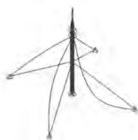
Rys. 7.119. Trzecia postać drgań własnych f_3 = 0.9606\text{Hz} .
