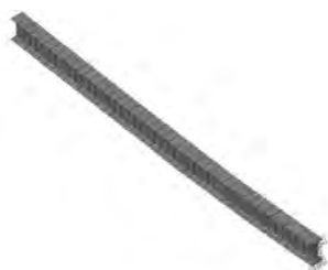
Rys. 6.15 Pierwsza postać drgań własnych dwuteownika ( f_1=34.2\text{Hz} ).
