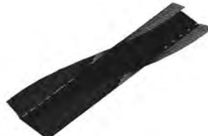
Rys. 7.33. Czwarta postać drgań własnych f_4 = 4.328\text{Hz} .
