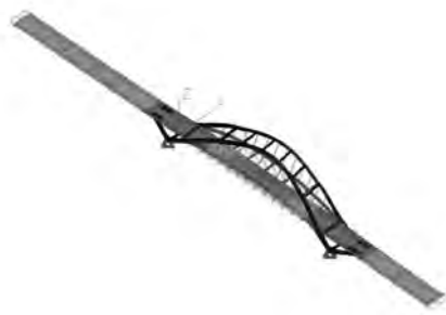
Rys. 7.65. Druga postać drgań własnych f_2 = 0.7575\text{Hz} .
