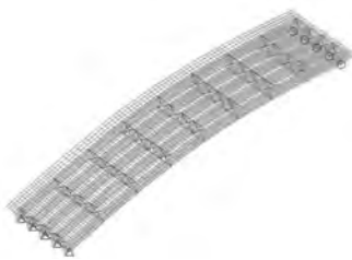
Rys. 7.103. Pierwsza postać drgań własnych f_1 = 1,983\text{Hz} .
