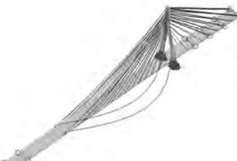
Rys. 7.79. Czwarta postać drgań własnych f_4 = 0,6663\text{Hz} .
