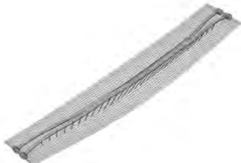
Rys. 7.96. Druga postać drgań własnych f_2 = 0,491 Hz.
