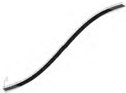
Rys. 7.18. Pierwsza postać drgań własnych f_1 = 2.403\text{Hz}
