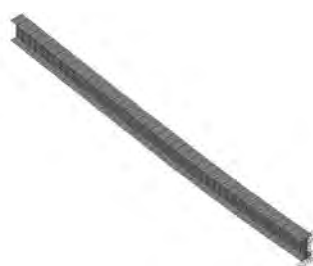
Rys. 6.14. Model MES dwuteownika zamocowany wspornikowo.
