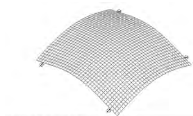
Rys. 6.4. Pierwsza postać drgań własnych modelu nr 1 ( f_1 = 6.826\text{Hz} ).
