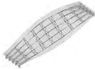
Rys. 7.104. Druga postać drgań własnych f_2 = 2,3298\text{Hz} .
