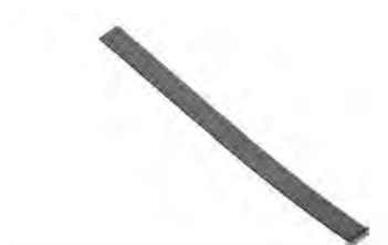
Rys. 6.28 Pierwsza postać drgań własnych ( f_1 = 4.3\text{Hz} )
