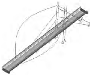
Rys. 7.8. Piąta postać drgań własnych f_5 = 4.069\text{Hz} .
