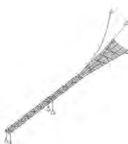
Rys. 7.49. Czwarta postać drgań własnych f_4 = 1.986\text{Hz} .
