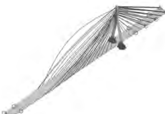
Rys. 7.78. Trzecia postać drgań własnych f_3 = 0,6600\text{Hz} .
