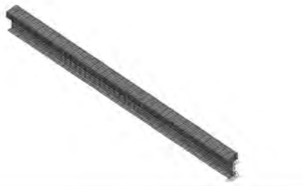
Rys. 6.20. Model MES dwuteownika z nakładką drewnianą.
