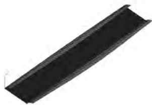
Rys. 7.30. Pierwsza postać drgań własnych f_1 = 3.995\text{Hz} .
