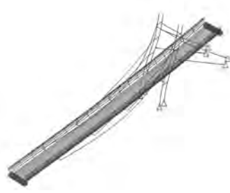
Rys. 7.5. Druga postać drgań własnych f_2 = 3.291\text{Hz} .
