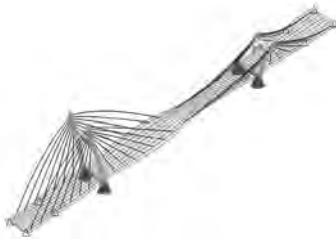
Rys. 7.90. Trzecia postać drgań własnych f_3 = 0,499\text{Hz} .
