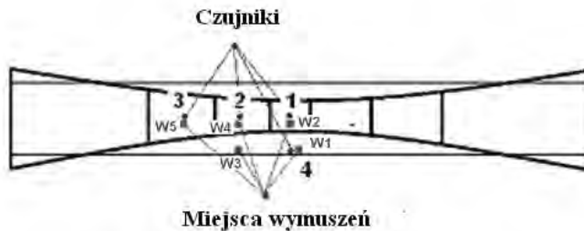
Rys. 7.69. Rozmieszczenie czujników przyspieszeń drgań na przęśle głównym z pokazaniem miejsc gdzie dokonywano wymuszenia (widok z góry).
