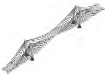
Rys. 7.88. Pierwsza postać drgań własnych f_1 = 0,432 Hz.
