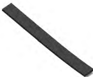
Rys. 6.33. Pierwsza postać drgań własnych ( f_1 = 4.3\text{Hz} )
