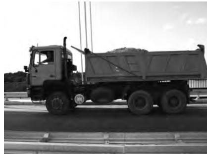
Rys. 7.63. Sprzęt wymuszający drgania.
