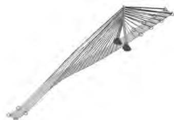
Rys. 7.76. Pierwsza postać drgań własnych f_1 = 0,4056\text{Hz} .
