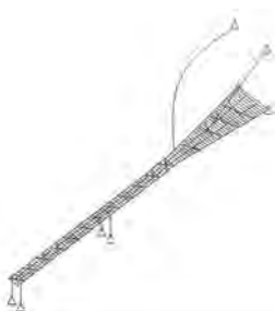
Rys. 7.48. Trzecia postać drgań własnych f_3 = 1.985\text{Hz} .
