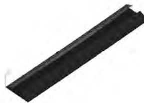
Rys. 7.31. Druga postać drgań własnych f_2 = 4.019\text{Hz} .
