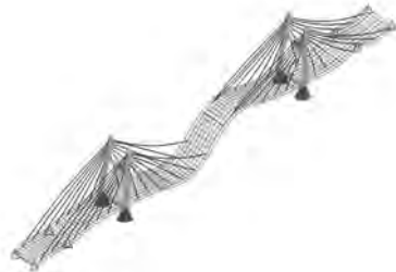
Rys. 7.91. Czwarta postać drgań własnych f_4 = 0,548\text{ Hz} .
