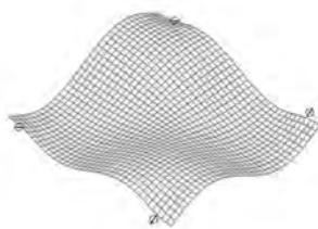
Rys. 6.6 Piąta postać drgań własnych modelu nr 1 ( f_1 = 34.997\text{Hz} )
