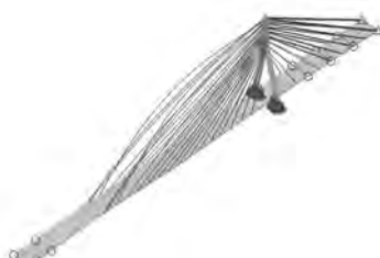
Rys. 7.77. Druga postać drgań własnych f_2 = 0,6592\text{Hz} .
