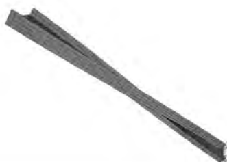
Rys. 6.16 Druga postać drgań własnych dwuteownika ( f_1=41.7\text{Hz} ).
