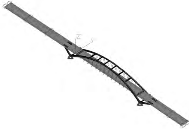
Rys. 7.59. Model MES mostu w Puławach.
