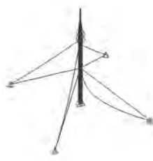
Rys. 7.121. Piąta postać drgań własnych f_5 = 0.9657\text{Hz} .
