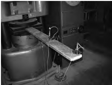
Rys. 6.31. Płaskownik stalowy i nakładka drewniana
