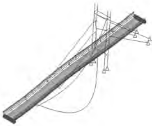
Rys. 7.6. Trzecia postać drgań własnych f_3 = 4.054\text{Hz} .
