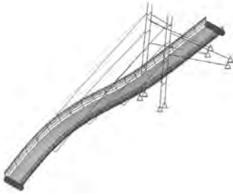
Rys. 7.4. Pierwsza postać drgań własnych f_1 = 2.171\text{Hz} .
