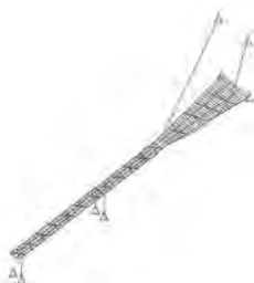
Rys. 7.46. Pierwsza postać drgań własnych f_1 = 1,983\text{Hz} .
