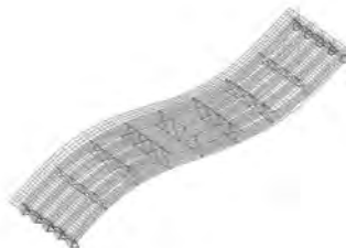
Rys. 7.105. Czwarta postać drgań własnych f_4 = 6,7063\text{Hz}
