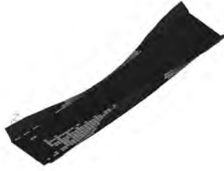
Rys. 7.34 Piąta postać drgań własnych f_5 = 4.790\text{Hz}
