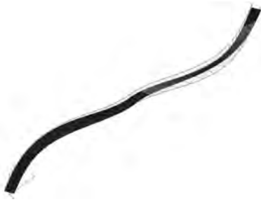
Rys. 7.20. Trzecia postać drgań własnych f_3 = 3.343\text{Hz}
