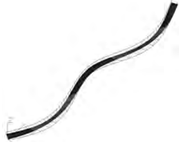
Rys. 7.21. Czwarta postać drgań własnych f_4 = 3.448\text{Hz}
