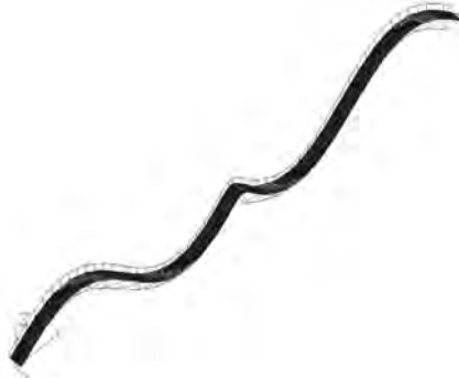
Rys. 7.22 Piąta postać drgań własnych f_5 = 6.097\text{Hz}
