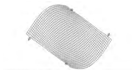
Rys. 6.5. Druga postać drgań własnych modelu nr 1 ( f_1 = 12.608\text{Hz} ).
