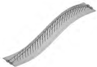
Rys. 7.95. Pierwsza postać drgań własnych f_1 = 0,426 Hz.
