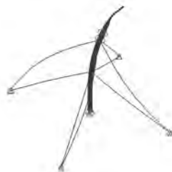
Rys. 7.118. Druga postać drgań własnych f_2 = 0.7259\text{Hz} .
