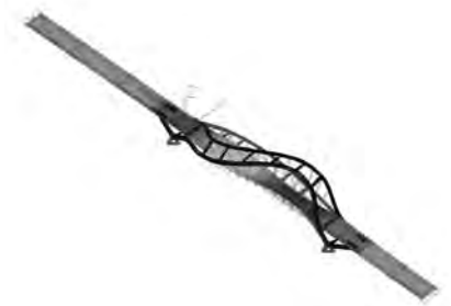
Rys. 7.67. Czwarta postać drgań własnych f_4 = 1.2743\text{Hz} .
