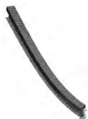
Rys. 6.21. Pierwsza postać drgań własnych modelu złożonego ( f_1 = 33.2\text{Hz} ).
