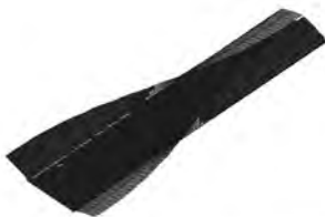
Rys. 7.32. Trzecia postać drgań własnych f_3 = 4.277\text{Hz} .
