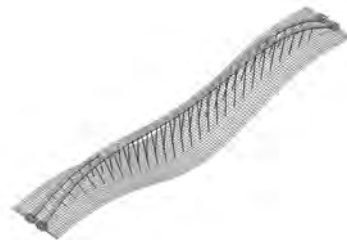
Rys. 7.98. Czwarta postać drgań własnych f_4 = 0,814\text{ Hz} .
