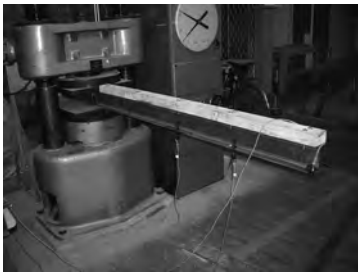
Rys. 6.19. Dwuteownik stalowy h=120\text{mm} i nakładka drewniana.
