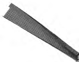
Rys. 6.22. Druga postać drgań własnych modelu złożonego ( f_2 = 42.2\text{Hz} ).
