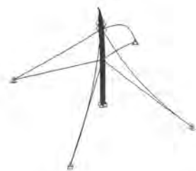
Rys. 7.117. Pierwsza postać drgań własnych f_1 = 0.7241\text{Hz} .
