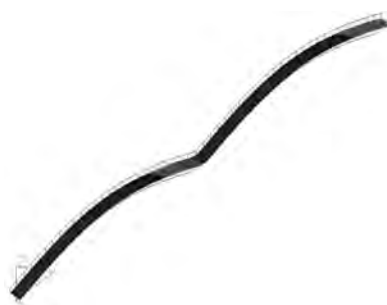
Rys. 7.19. Druga postać drgań własnych f_2 = 2.407\text{Hz}
