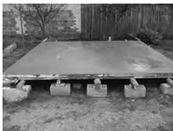
Rys. 6.1 Płyta żelbetowa oparta na dwóch dwuteownikach.
