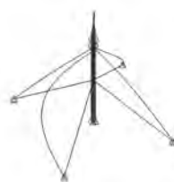
Rys. 7.120. Czwarta postać drgań własnych f_4 = 0.9632\text{Hz} .
