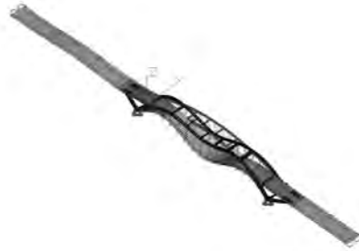
Rys. 7.68. Piąta postać drgań własnych f_5 = 1.3377\text{Hz} .
