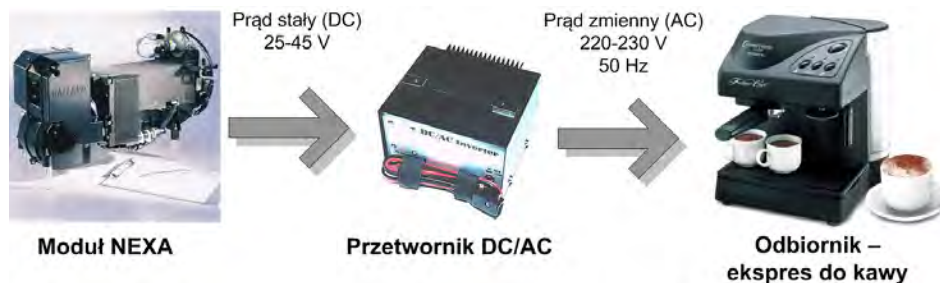
Rys. 6.1. Zasilanie ekspresu do kawy z modułu ogniw paliwowych NEXA
