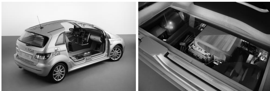
Rys. 6.4. Układ napędowy oparty na ogniwach paliwowych PEM firmy Ballard umieszczony w płycie podłogowej Mercedesa B klasy
