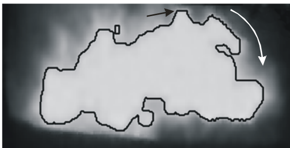
Rys. 4.9. Przykładowy kontur płomienia z zaznaczonym punktem startowym oraz kierunkiem obiegu
