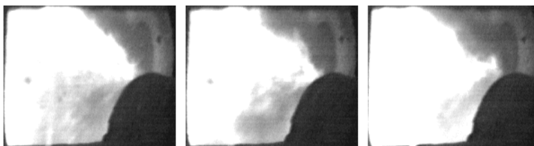
Rys. 2.6. Przykładowa sekwencja obrazów zarejestrowana przy stabilnym spalaniu pyłu węglowego w odstępach czasu wynoszących 1/25s
