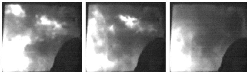
Rys. 2.5. Sekwencja obrazów zarejestrowana podczas spalania niestabilnego pyłu węglowego w odstępach czasu wynoszących 1/25s
