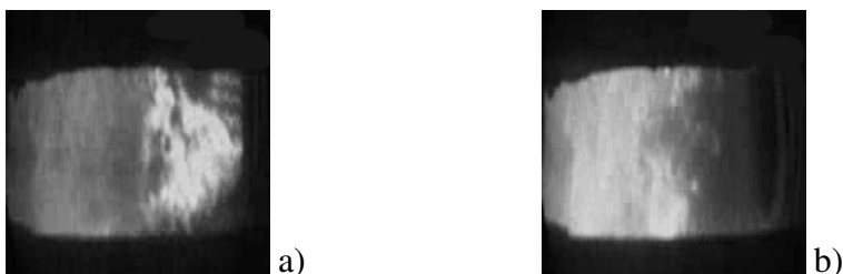
Rys. 6.19. Obrazy zarejestrowany podczas: s) stabilnego, b) niestabilnego spalania pyłu węglowego analizowane za pomocą transformaty curvelet.
