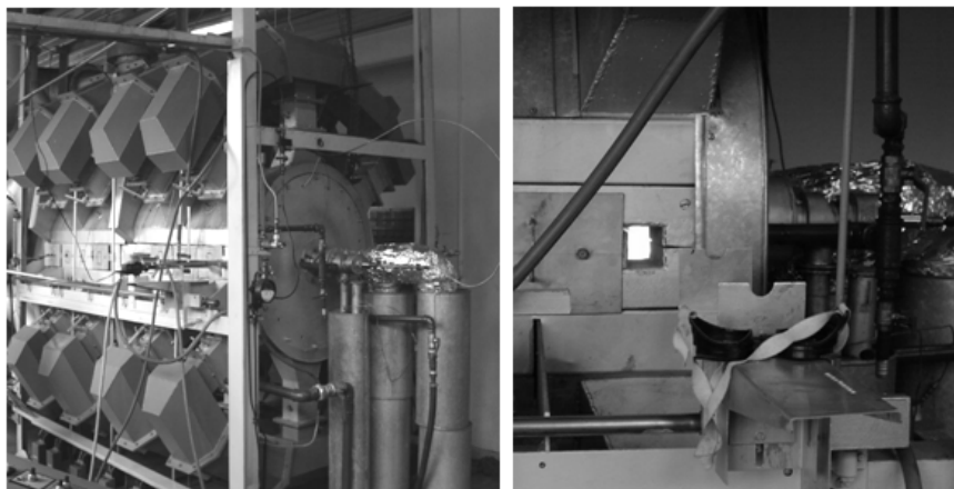
Rys. 6.1. Widok stanowiska pomiarowego z zaznaczonym miejscem usytuowania kamery, prostopadle do osi palnika (na rys. 6.2 oznaczone jako położenie 1)
