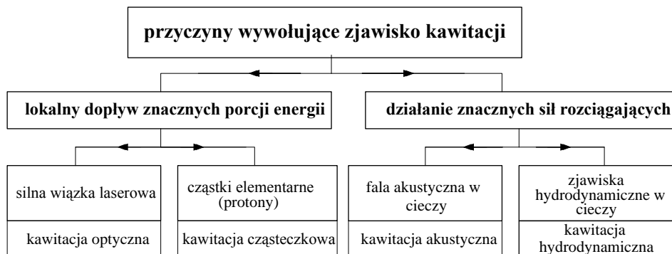
Rys. 1. Główne przyczyny wywołujące zjawisko kawitacji
