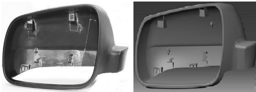
Rys. 24. Porównanie pierwowzoru oraz modelu brylowego CAD
