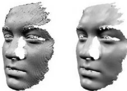
Rys. 6. Model powierzchniowy twarzy ludzkiej uzyskany z chmury punktów „surowej” i filtrowanej [4]
