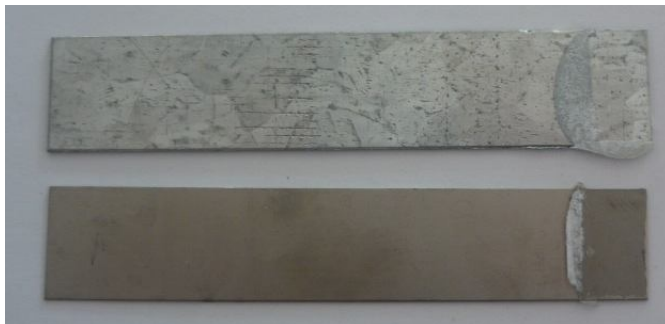
Fot. 3. Widok próbki zniszczonego połączenia klejowego po badaniach niszczeniowych
