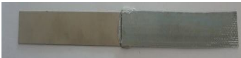
Fot. 1. Przykład wykonanego połączenia klejowego blachy stalowej ocynkowanej elektrolitycznie i blachy tytanowej
