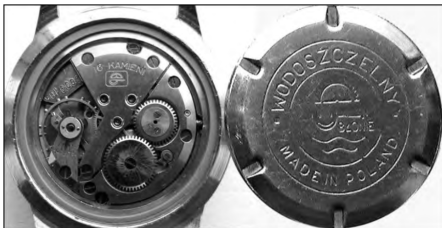
Rys. 1. Zegarek zmontowany z części wyprodukowanych w Z.M.P „Błonie” (nr płyty 0000106), z charakterystycznym logo zakładu, wytłoczonym na mostku przekładni chodu i wieczku koperty (foto autora)
