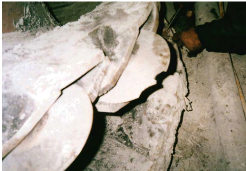
Rys. 2. Zniszczone sworznie dyskowe na tarczy odcinającej
