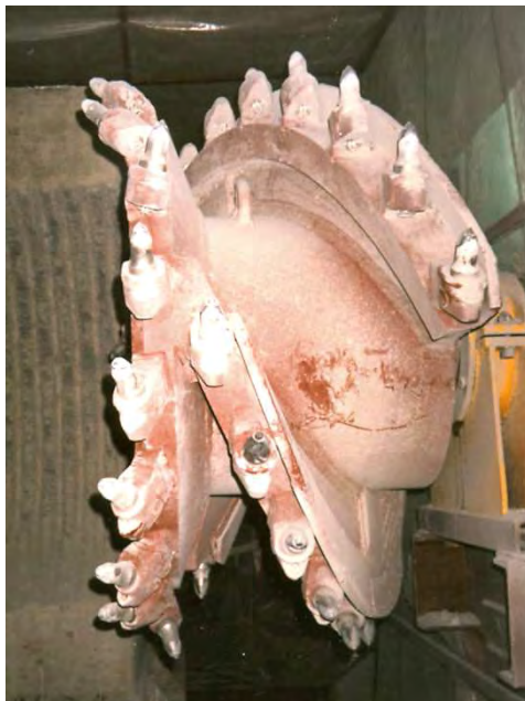
Rys. 6. Frezujący organ ślimakowy z nożami styczno-obrotowymi (CX-18/30/38/50/165/ZH)
