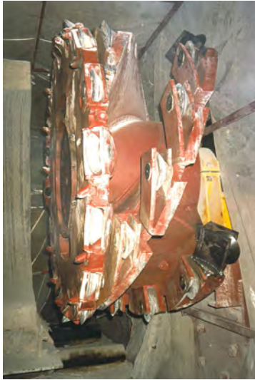
Rys. 17. Frezujący organ ślimakowy (wersja IV) na stanowisku badawczym
