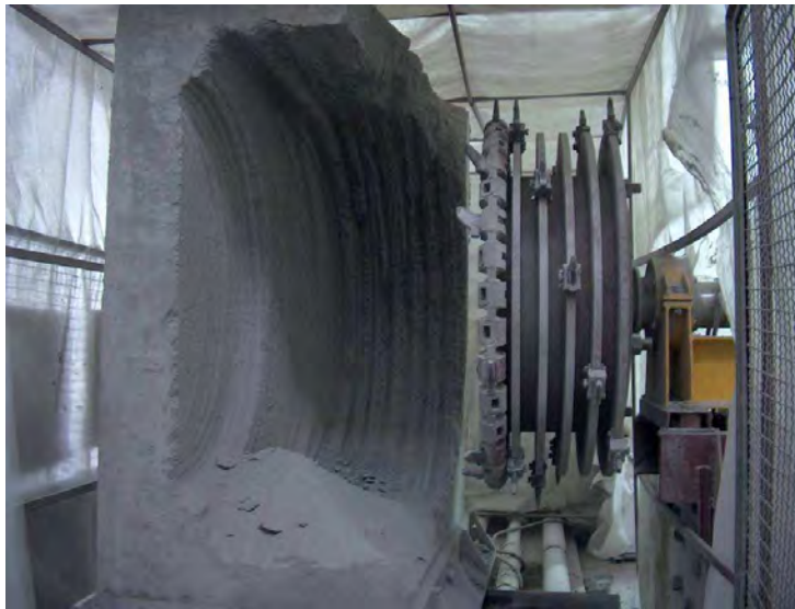
Rys. 6. Stanowisko badawcze, blok skalny po urabianiu
