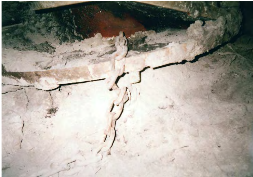
Rys. 2. Zniszczone sworznie dyskowe na tarczy odcinającej
