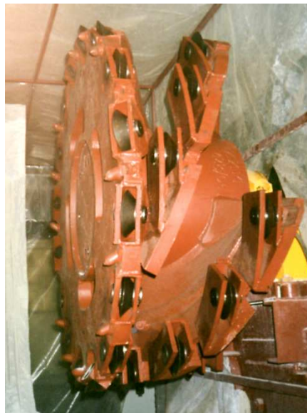
Rys. 5. Frezujący organ ślimakowy na stanowisku badawczym
