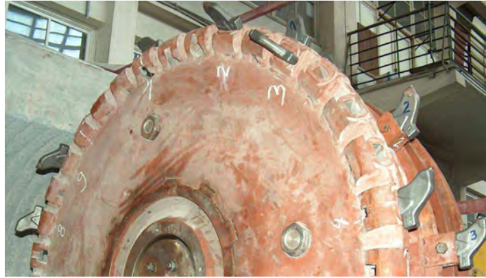
Rys.5. Głowica wielonarzędziowa zamontowanymi nożami promieniowymi
