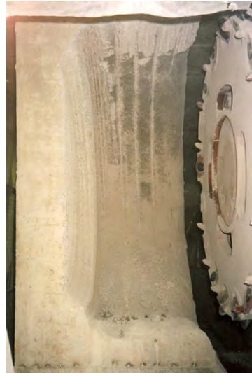
Rys. 18. Próbką skalną ( R_c = 13,73 MPa) ze śladami skrawów i brakiem śladów kontaktu organu z calizną
