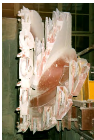
Rys. 15. Widok organu z dyskami na stanowisku badawczym ze śladami kontaktu płatów z calizną
