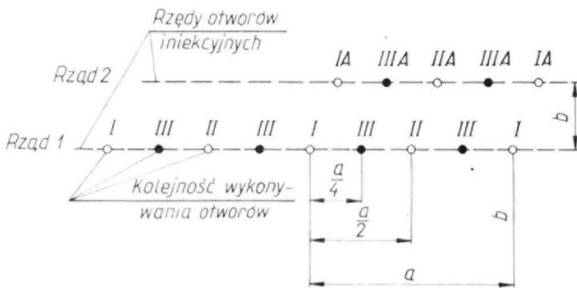
Rys. 3. Przykład kolejności realizacji otworów przy prowadzeniu iniekcji w dwóch rzędach
