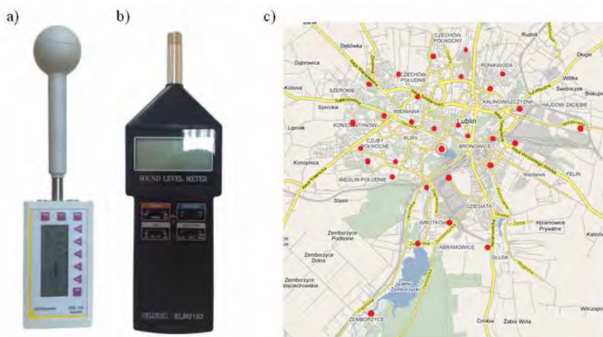
Rys. 1. Miernik MESCHEK 100 a), Miernik ELM 2152 b), mapa Lublina z punktami pomiarowymi c)
