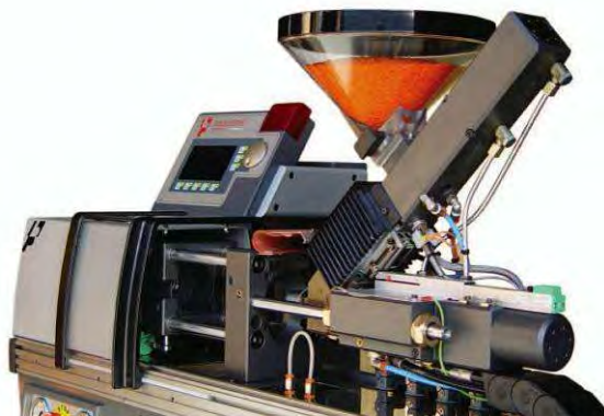
Rys. 3. Ślimakowo-tłokowy układ uplastyczniający we wtryskarce do mikrowtryskiwania firmy Babyplast [10]
