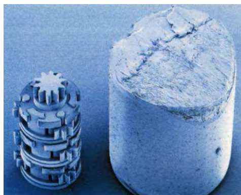
Rys. 7. Trzystopniowa przekładnia planetarna złożona z 15 mikrowyprasek z poliacetalu, z których najmniejsza waży około 0,04 mg, obok dla porównania wymiarów granulka tworzywa [10]
