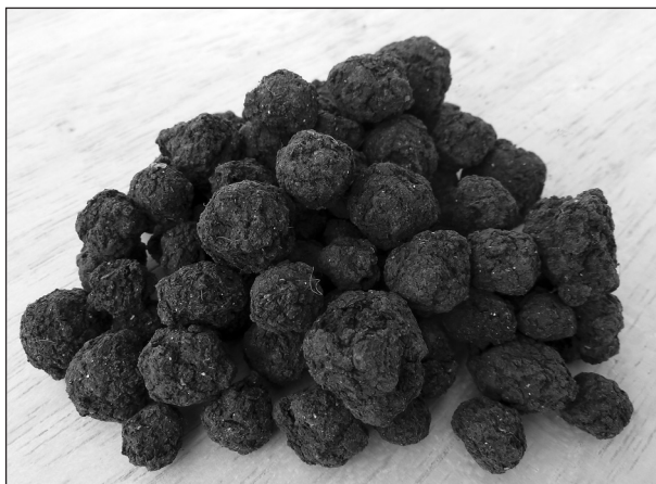
Rys. 31. Granule osadów ściekowych ze stacji termicznego osuszania w oczyszczalni ścieków „Hajdów” w Lublinie
